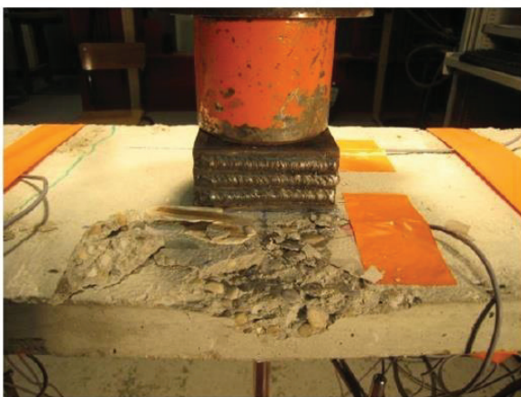
Eclatement du béton initiant la rotule plastique
