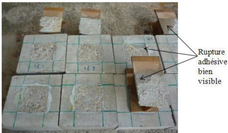
Figure 3.56 : Eprouvettes de la série PO16 rompues
