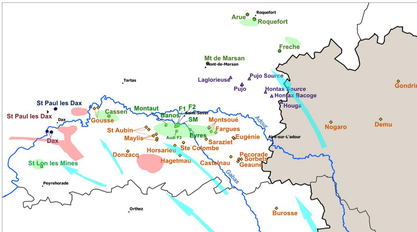
Figure 4-1 : Localisation des forages des différentes masses d'eau pour la caractérisation spatiale de la chimie des eaux souterraines régionales (ronds et carrés verts : base et sommet du Crétacé, losanges oranges : Eocène-Paléocène, pentagone bleus : Oligocène, triangle rouge : Miocène, triangles violets : Mio-Pliocène)
