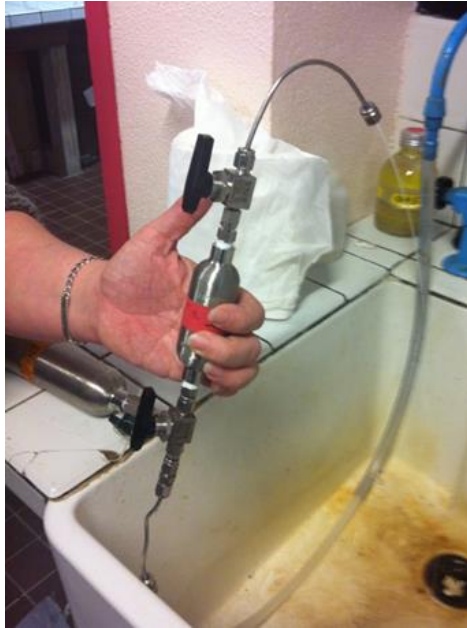
Figure 2-7: Ampoule en acier de 30 ml utilisée pour le prélèvement des CFCs
