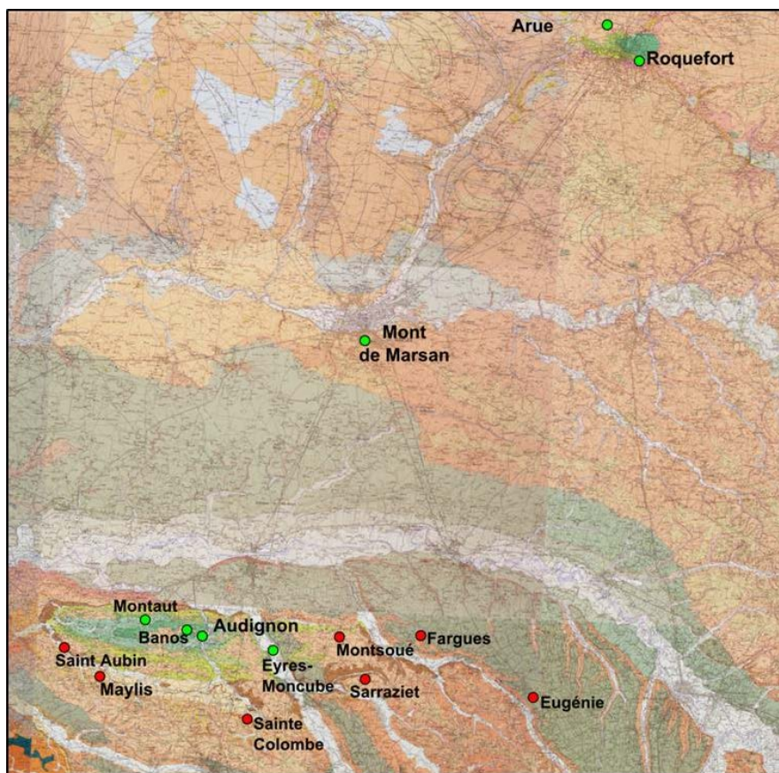
Figure 1-24 : Localisation des forages suivis pour la caractérisation des eaux souterraines régionales du Crétacé (vert) et de la masse d'eau Eocène-Paléocène (rouge) sur fond de carte géologique au 1/50 000 ème (BRGM, Infoterre)
