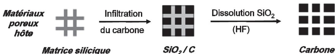
Figure 1: Méthodologie d'obtention des matériaux carbonés par la technique de réplique<sup>9</sup>.
