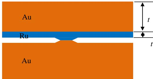
Figure 4.19 Contact avec structure multicouche.
