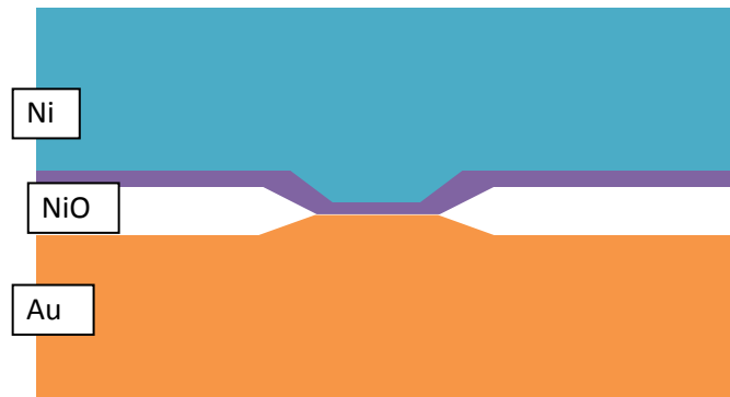
Figure 4.25 Modèle de contact Au-Ni avec film résistif uniforme
