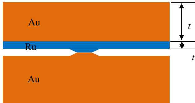
Figure 4.19 Contact avec structure multicouche.
