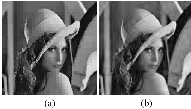
figure 12: reconstruction utilisant 1% des coefficients de détail, (a) ondelettes de Haar, (b) ondelettes linéaires
