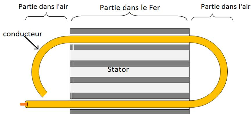
Figure IV.8 ; schéma descriptif de la partition d'une spire
