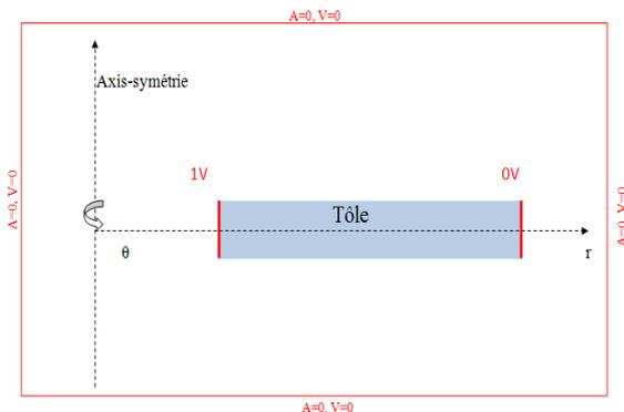
Figure I.14 : schéma descriptif de la simulation EF
