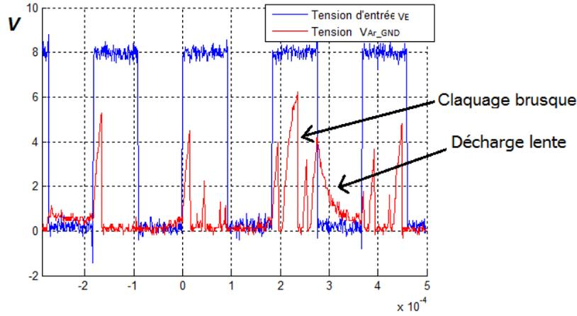
Figure II.34 : mesure de la tension de roulements
