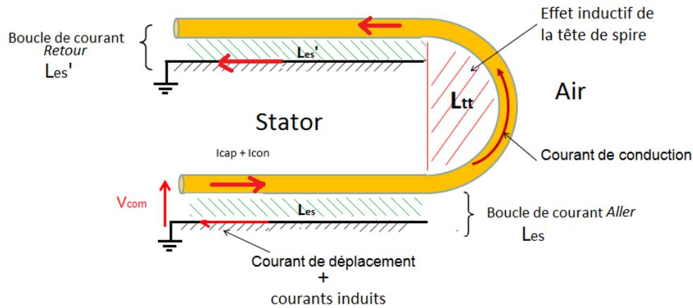
Figure IV.22 : schéma descriptif des différentes boucles de courant
