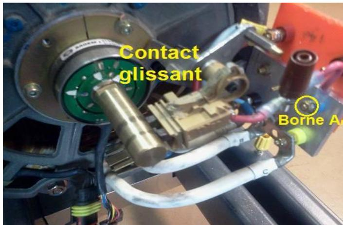
Figure II.15 : vue sur le contact glissant
