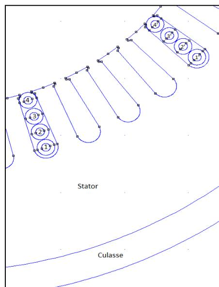
Figure IV. 23 : Zoom sur la géométrie du modèle EF
