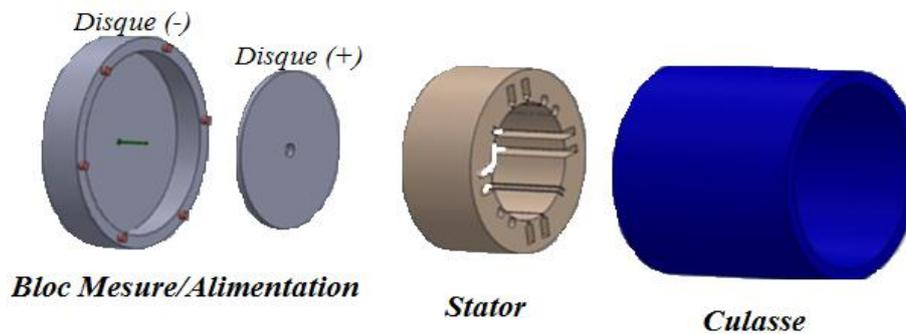
Figure III.1 : vue 3D de la maquette
