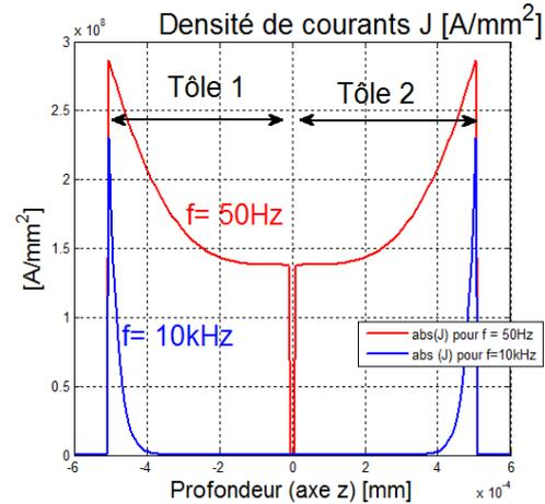
Figure I.21 : Répartition de la densité de courant selon l'axe z pour  $f = 10$  kHz et  $f = 50$  Hz
