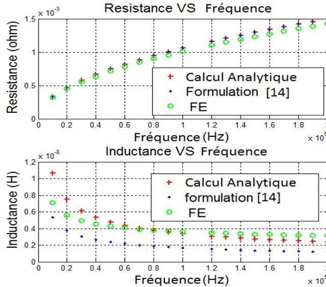
Figure. I.28: Comparaisons entre les résultats de calcul de l'impédance de surface  $Z_{ss}$  avec deux méthodes et confrontation au résultat EF
