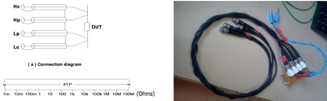
Figure II.11 : Dispositif de mesure en quatre points
