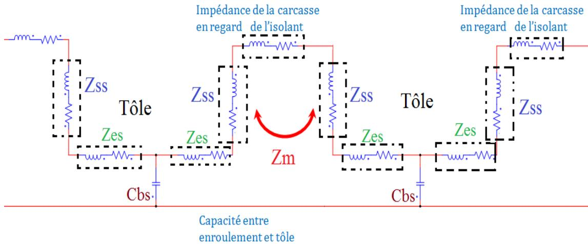
Figure I. 26 : schéma descriptif de la méthodologie utilisée pour l'élaboration du modèle circuit
