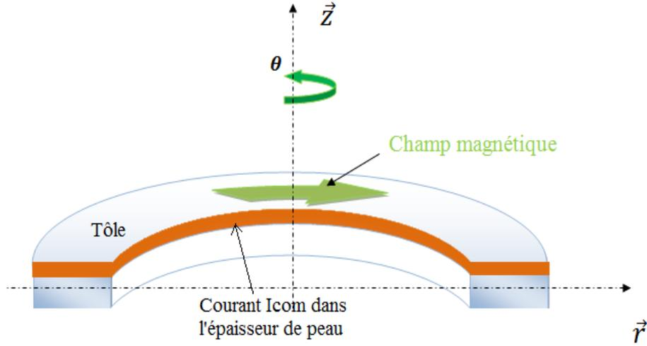
Figure I.27: Schéma descriptif de la configuration du courant et du champ magnétique à la surface de la tôle.
