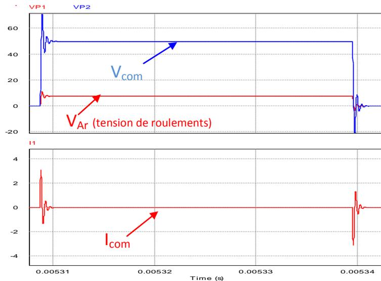
Figure II.23 : simulation de la tension de roulements
