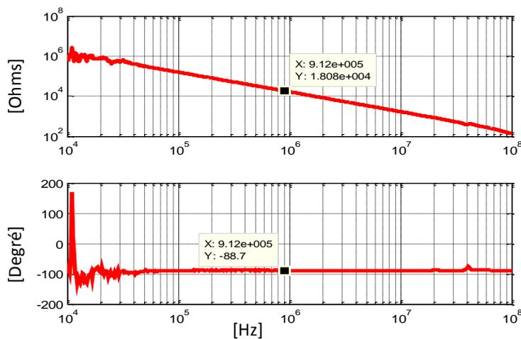
Figure IV.14 : impédance mesurée des deux conducteurs
