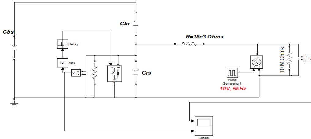
Figure II.37 : modèle SIMULINK de l'expérimentation : injection de tension entre les bornes A<sub>r</sub>
