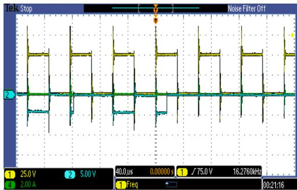
Tension de roulements (courbe bleu) pour une vitesse : 863,33 tr/min
