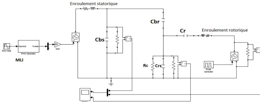
Figure II.39 : modèle SIMULINK d'une excitation simultanée des enroulements statorique et rotorique
