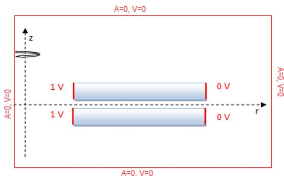
Figure I.18 : Schéma descriptif de la simulation EF
