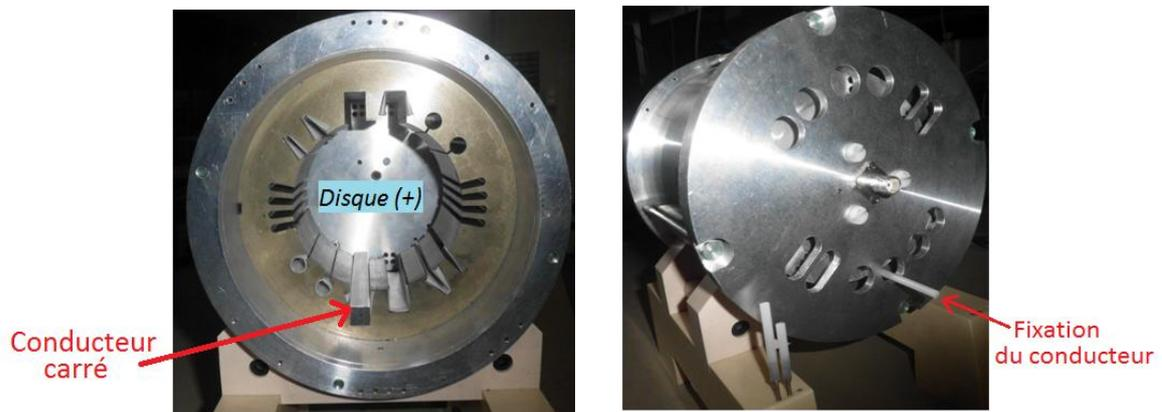
Figure III.6 : configuration de mesure de la capacité entre un conducteur carré et encoche carré
