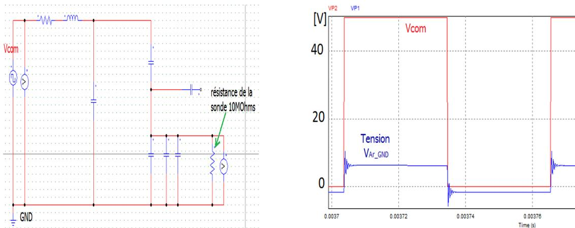
Figure II.28 : résultats de simulation de la tension de mode commun  $V_{com}$  et la tension de roulements  $V_r$  en introduisant une résistance de 10 MΩ (impédance de la sonde) en parallèle à la capacité  $C_{eq}$  et une autre en parallèle avec  $C_{bs}$  pour simuler l'impédance de la sonde
