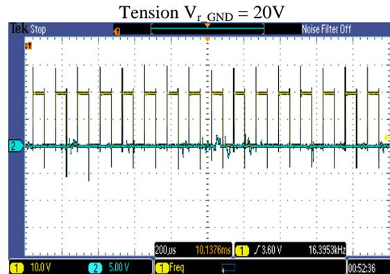
Une autre seconde série de mesure a été effectuée dans le but de mettre en évidence l'influence de la vitesse de rotation ainsi que l'état du moteur, à chaud et à froid, sur la tension de roulements. Pour les deux états du moteur, l'enroulement rotorique est excité avec une tension de 5 V et de fréquence de 16,2 kHz. Cette tension d'excitation induit une tension de roulements d'environ 2,5 V. Les résultats de mesure sont regroupés dans le tableau II.3.
