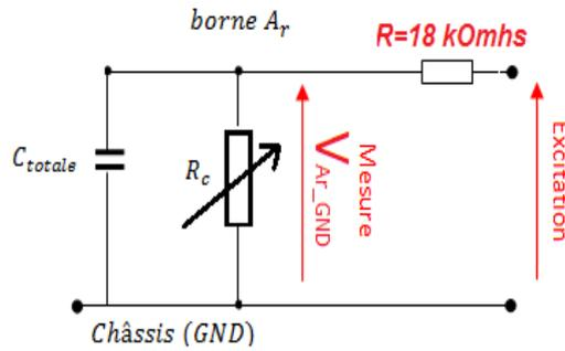
Figure II.35 : Circuit équivalent
