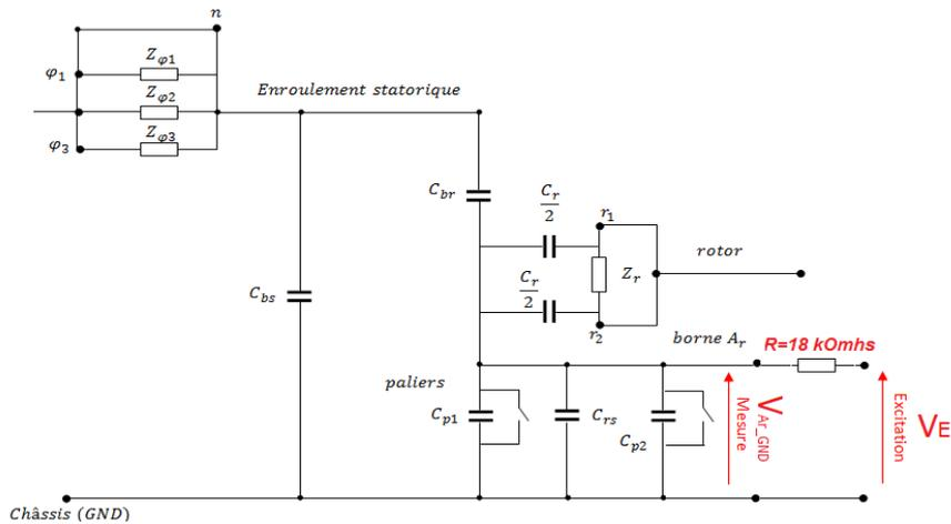
Figure II.33 : Schéma descriptif de la mesure
