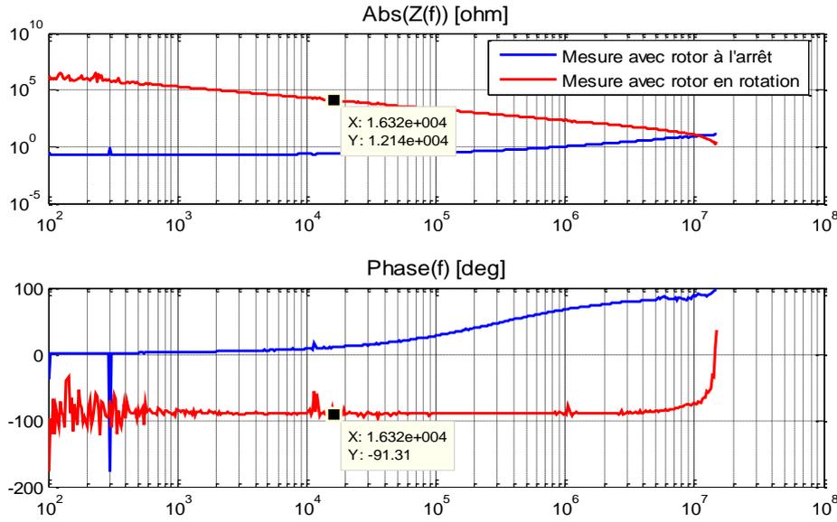
Figure II.20 : résultat de mesure d'impédance pour l'étape III
