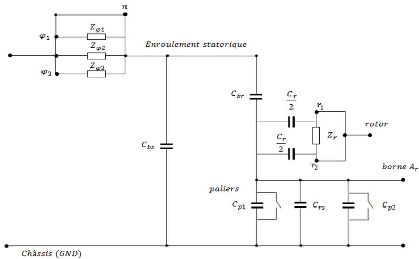
Figure II.14 : schéma descriptif de la configuration adoptée pour la mesure d'impédance.
