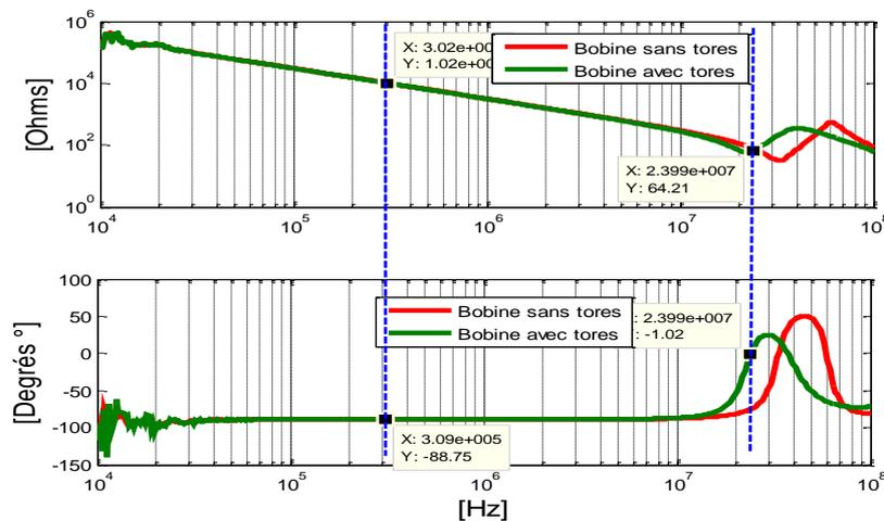
Figure IV.7 : résultat de mesure de l'impédance de mode commun de la bobine d'étude (en insérant les tores)
