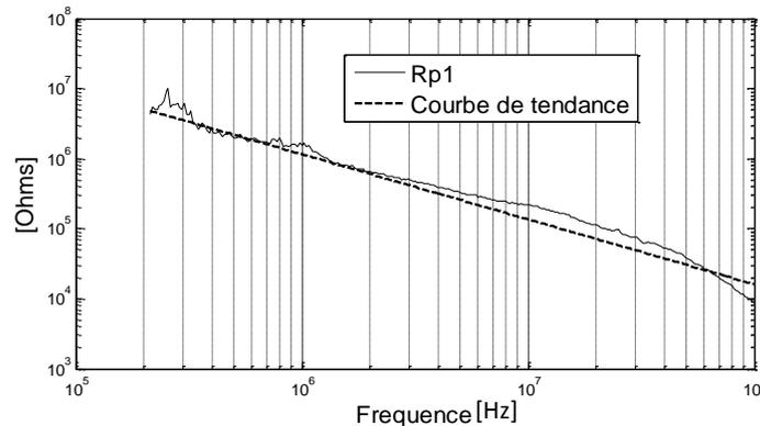
Figure IV.21 : Confrontation de la courbe de tendance à la courbe de mesure du paramètre  $R_{p1}$
