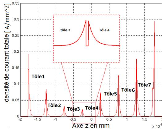
Figure. I.6: distribution de la densité de courants dans les tôles selon l'axe z pour une fréquence  $f = 10$  kHz
