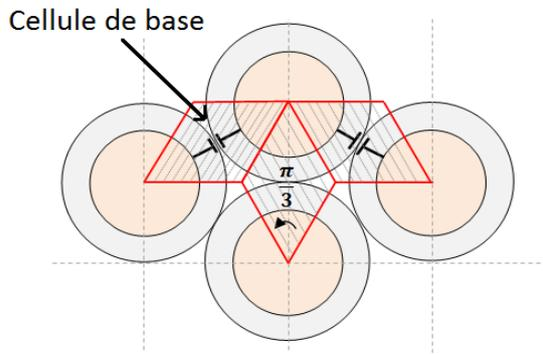
Figure III.15 : cellule de base pour le calcul de capacité inter-conducteur pour l'arrangement (b)
