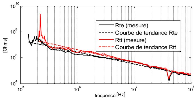
Figure IV.18 : Confrontation de la courbe de tendance à la courbe de mesure du paramètre  $R_{te}$
