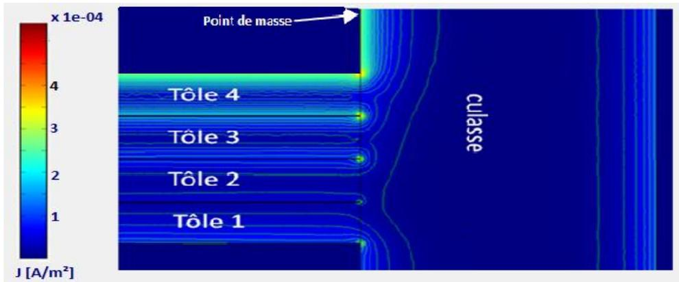
Figure. I.8 : simulation EF 2D axisymétrique, électromagnétique : Pour  $f = 100$  Hz : une partie des courants traversent la culasse
