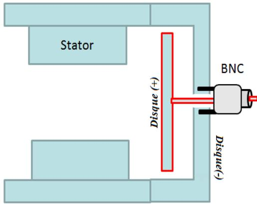
Figure III.4 ; schéma descriptif de la compensation à vide
