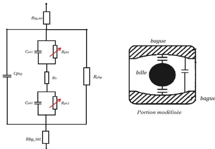
Figure II.7 : Circuit électrique équivalent à roulement en fonctionnement
