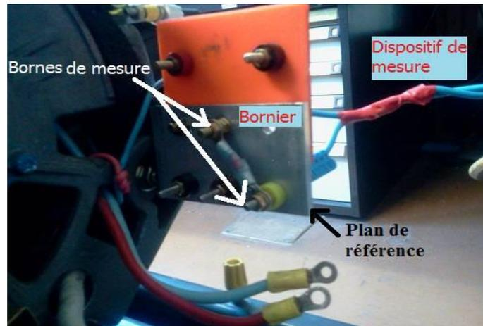
Figure II.12 : mesure de compensation; essai en court circuit
