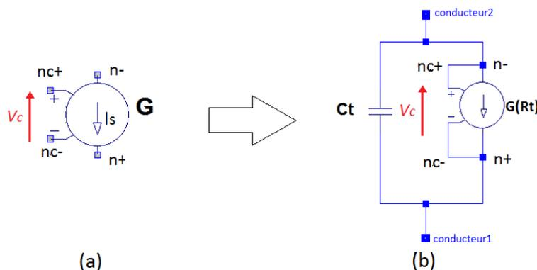
Figure IV.19 : (a) Source contrôlée "voltage dependent current source" de la bibliothèque du logiciel LTSPICE utilisée pour modéliser le paramètre  $R_{te}$  et  $R_{tt}$ , (b) modèle complet de la capacité non linéaire ( $C_t // R_t$ )
