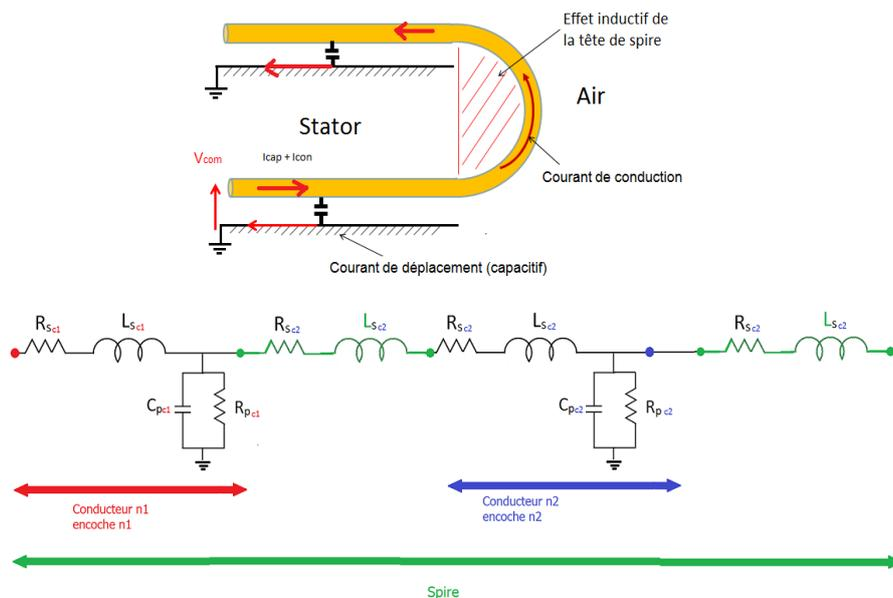
Figure IV.9 : modèle électrique d'une spire dans l'encoche
