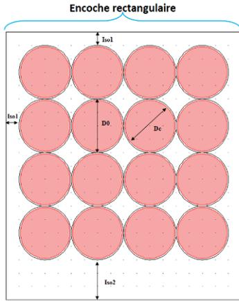
Figure III.27 : arrangement (a) dans une encoche rectangulaire
