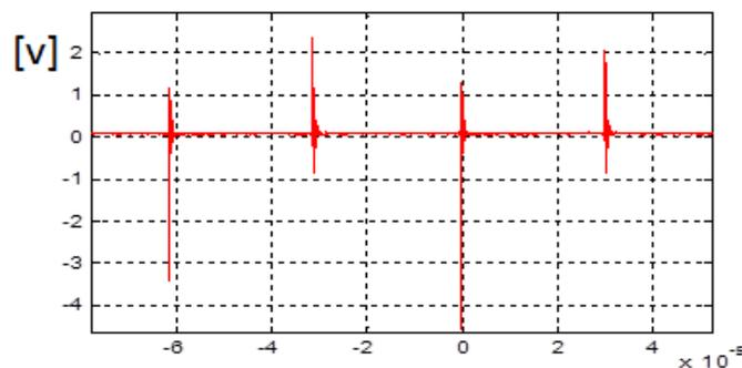
Figure II.26 : tension de roulements mesurée rotor à l'arrêt
