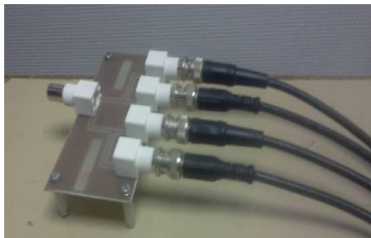
Figure III.3 : dispositif de mesure en quatre points avec sortie BNC
