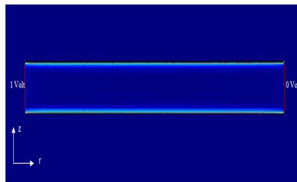
Figure I.15 : répartition de la densité de courant dans une tôle
