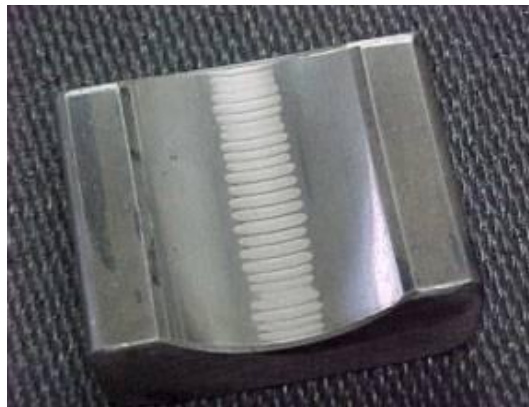
Figure 3: vue au microscope optique de la surface interne de la bague externe d'un roulement
