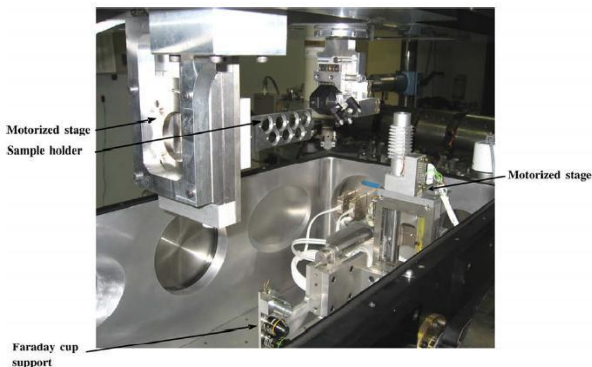
Figure 4-2 : Intérieur de la chambre à vide avec le moteur XYZ pour le déplacement de l'échantillon, des cages de Faraday pour stopper le faisceau, un détecteur STIM pour la mesure de l'énergie résiduelle ainsi que deux microscopes assurant le réglage du faisceau.
