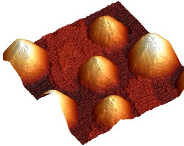
F-4: Image STM ( 75 \times 75 \text{ nm}^2 ) des boîtes quantiques (In,Ga)As/GaP.
