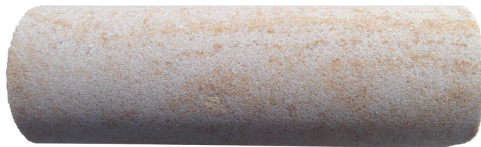
Figure 41. Carotte de roche poreuse utilisée pour les perméations
