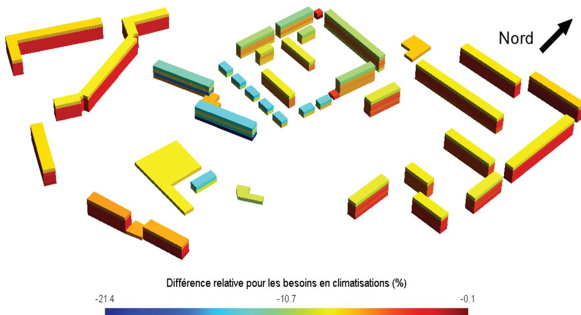
Figure 79: Variation des besoins en climatisation entre les scénarios M3 et P3
