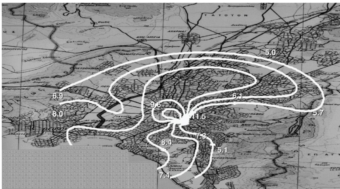
**Figure 3 : Valeurs des besoins en climatisation de la ville d'Athènes pour le mois d'août 1996 en kWh/m<sup>2</sup> (Santamouris et al., 2001)**
