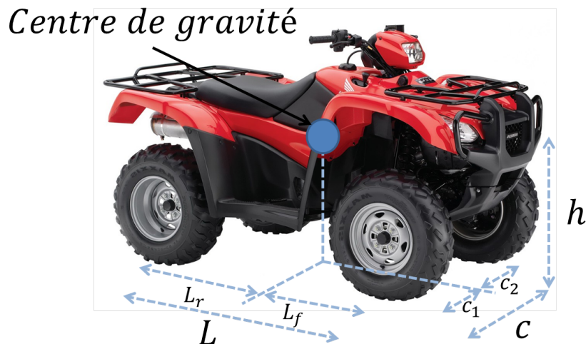
FIGURE 1.16 – Longueurs caractéristiques d'un quad
