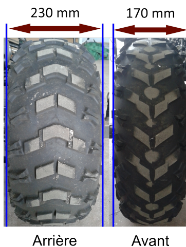
FIGURE 3.29 – Différence de largeur entre le pneumatique arrière (gauche) et avant (droite)
