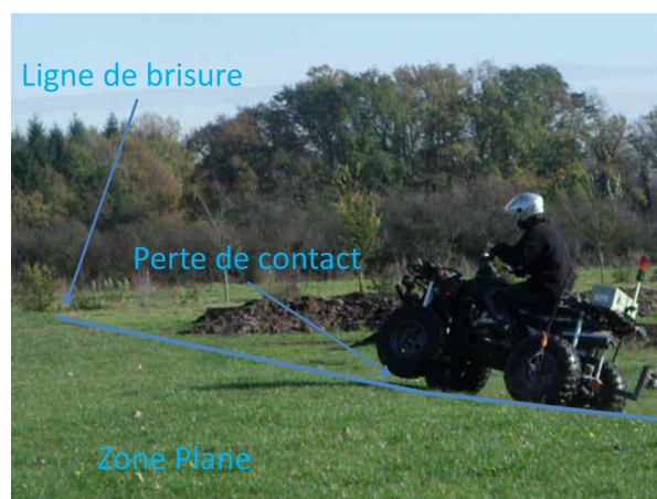
FIGURE 4.17 – Mise en évidence du soulèvement de la roue avant gauche lors du passage de la ligne de brisure
