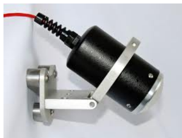
FIGURE A.8 – Radar Doppler DRS1000 pour la mesure de la vitesse linéaire du véhicule.
