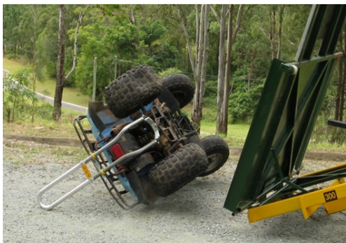
FIGURE 1.9 – Principe de fonctionnement de la Lifeguard et de la Quadbar
