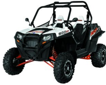
FIGURE 1.7 – Quad équipé d’une structure de protection de type ROPS
