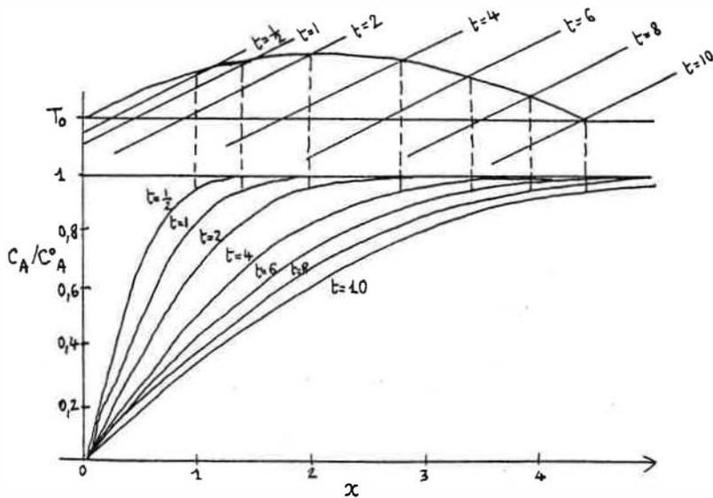
Fig. 83 : mécanisme de la cristallisation oscillatoire (Mc Birney et Noyes, 1979)
