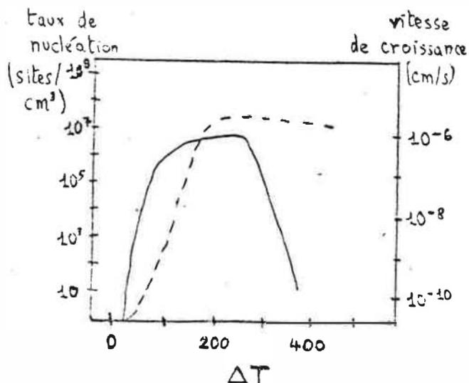
Fig. 93 : cristallisation du feldspath alcalin dans un granite synthétique (Swanson, 1977)
