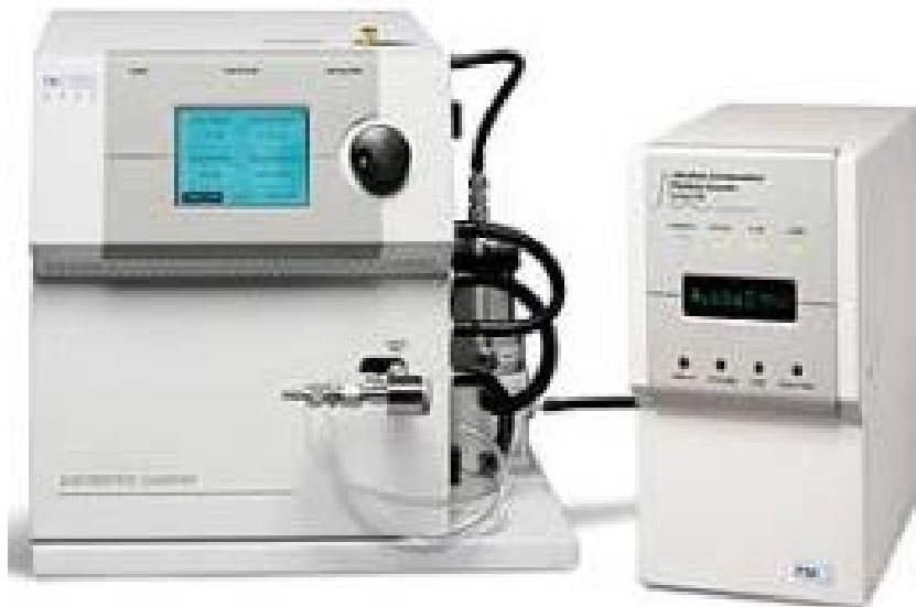
Figure 1.3: Photo du SMPS modèle 3936 extraite du manuel d'utilisation de l'instrument.
