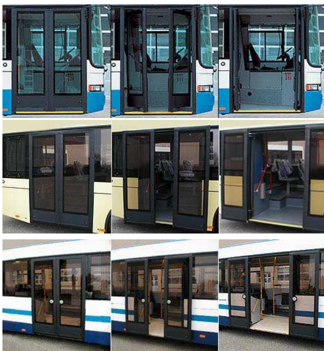
FIGURE 5.1 – Les principaux systèmes de porte louvoyante : intérieure (haut), extérieure (milieu), ou coulissante (bas).
