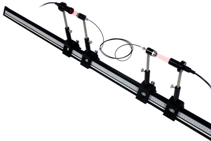
Figure 21. La transparence d'une fibre optique se mesure très facilement en connectant une source laser au départ et un détecteur à l'arrivée de la fibre. (D'après Dida Concept)
