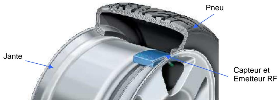
Figure.2.1: principaux éléments constructifs d'une source TPMS
