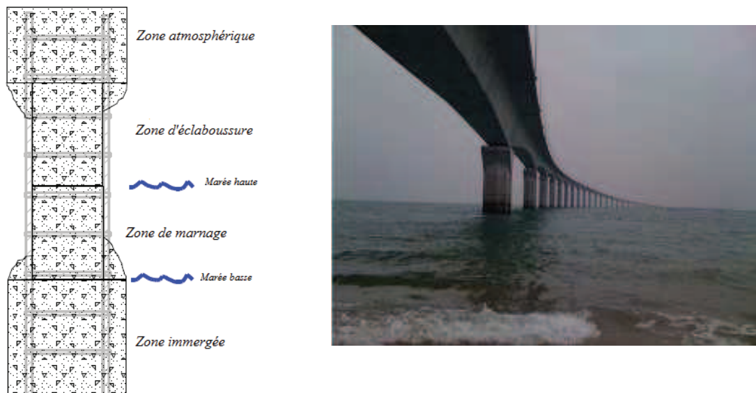
Figure 1.1 : Zones d'exposition en site maritime [Steven, 99] et exemple d'un ouvrage exposé à l'environnement marin (pont de l'île de Ré) (Photo : Pierre-Yves Mahieux)
