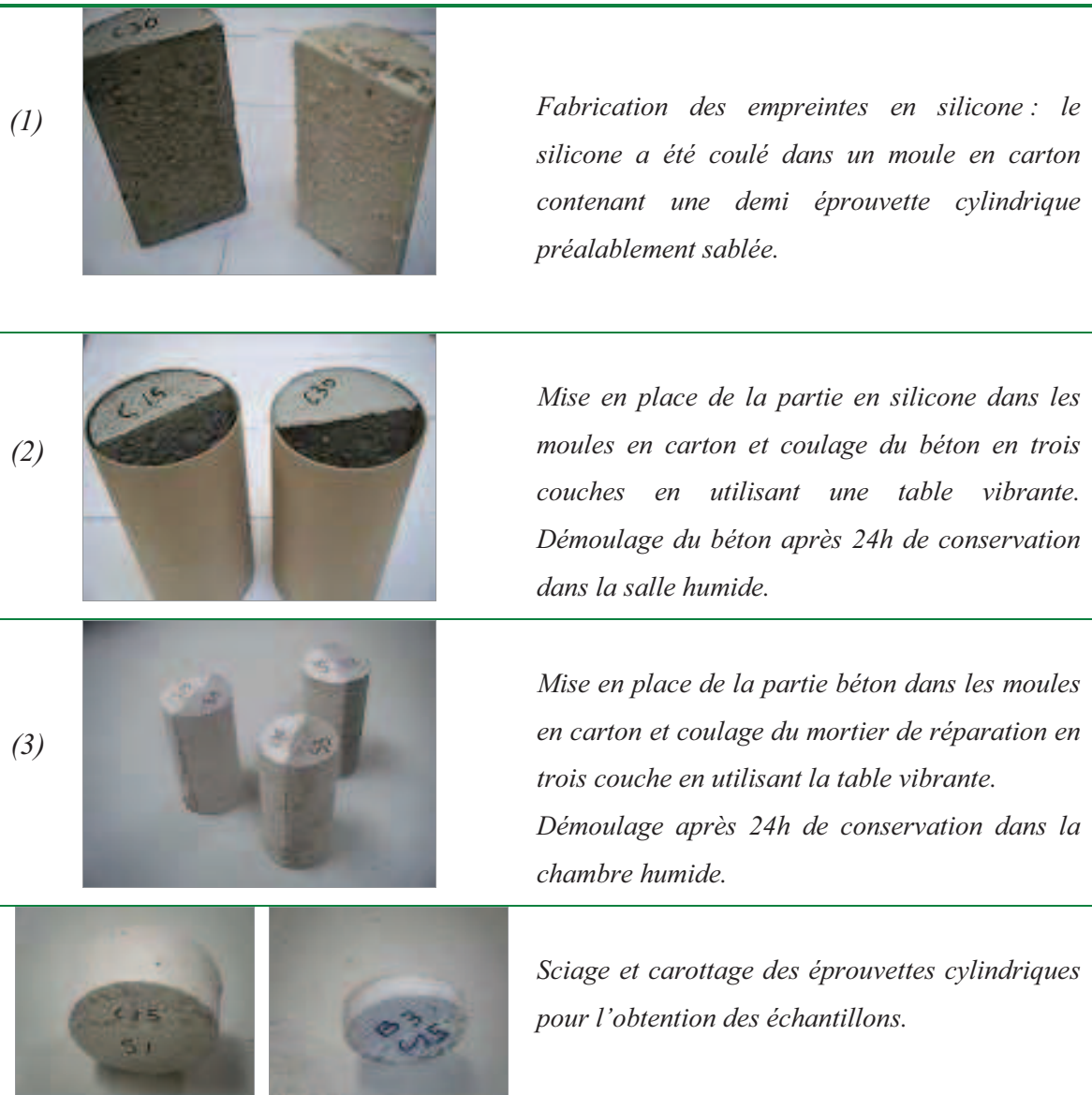
Figure 2.2 : Etapes de confection des éprouvettes mortier-béton
