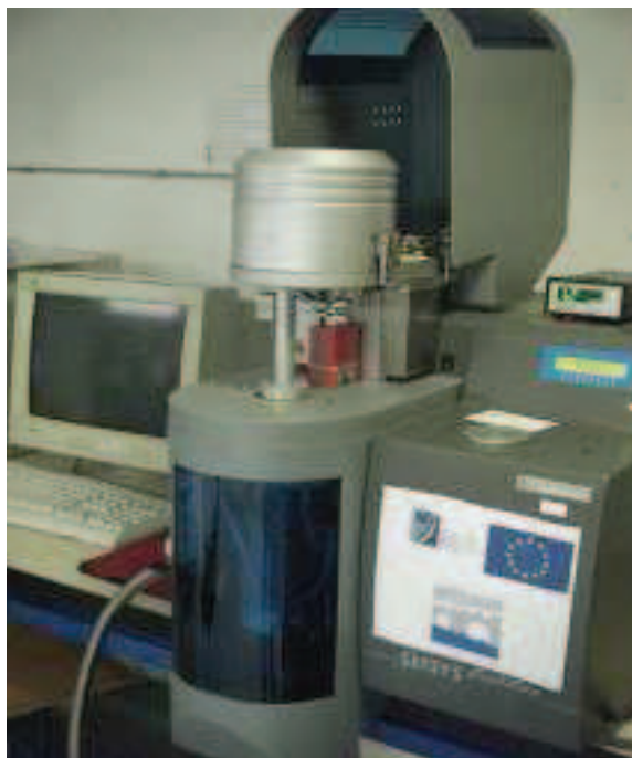
Figure 2.3: Dispositif expérimental pour l'analyse thermogravimétrique
