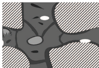
Figure 1.7 : Modèle de formation de la co-matrice polymère-ciment [Van Gemert, 05]
