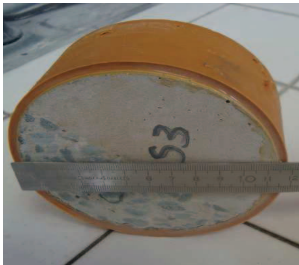
Figure 3.44 : Photographie d'un échantillon avec interface pour l'essai d'absorption capillaire
