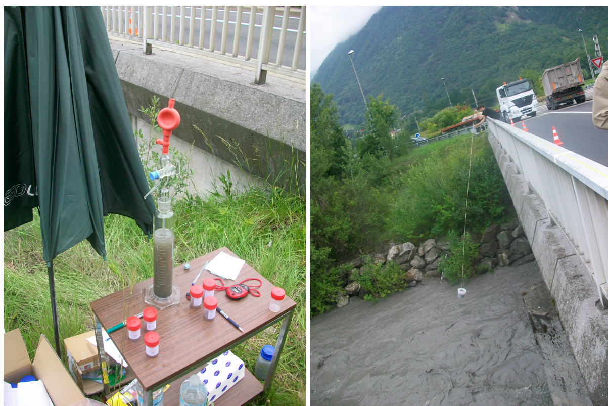
FIGURE 6.9 – Laboratoire de terrain et prélèvement au seau pendant la chasse de barrage de 2011, sur le site A5
