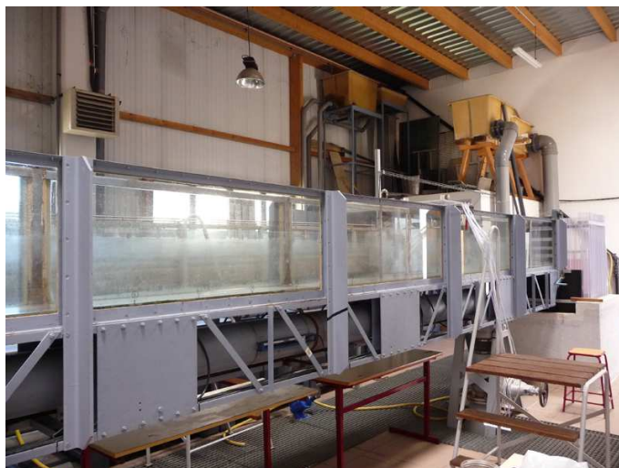
FIGURE 5.6 – Vue générale du petit canal de l'ENSAM. Le canal mesure 5,90 m de long. L'espace entre chaque structure métallique verticale est de 1,38 m.
