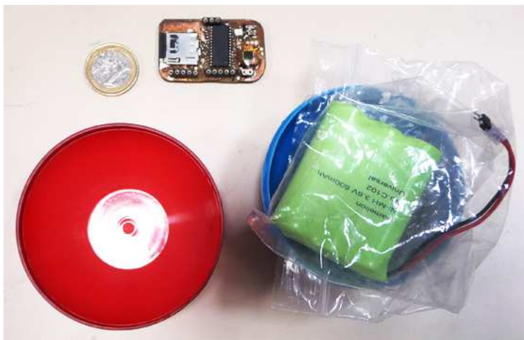
FIGURE 5.5 – Photographie d’une première version de module instrumenté. La CI est en haut à gauche de l’image. Les composants électroniques sont assemblés sur un circuit de taille réduite ( 4,7 \times 3 \times 0,8 cm). Ce module instrumenté est utilisé pour les expériences de validation avec le bloc de batterie (vert) présent sur la photographie.
