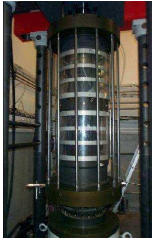
FIGURE 1.9 – Essai triaxial appliqué sur le ballast
