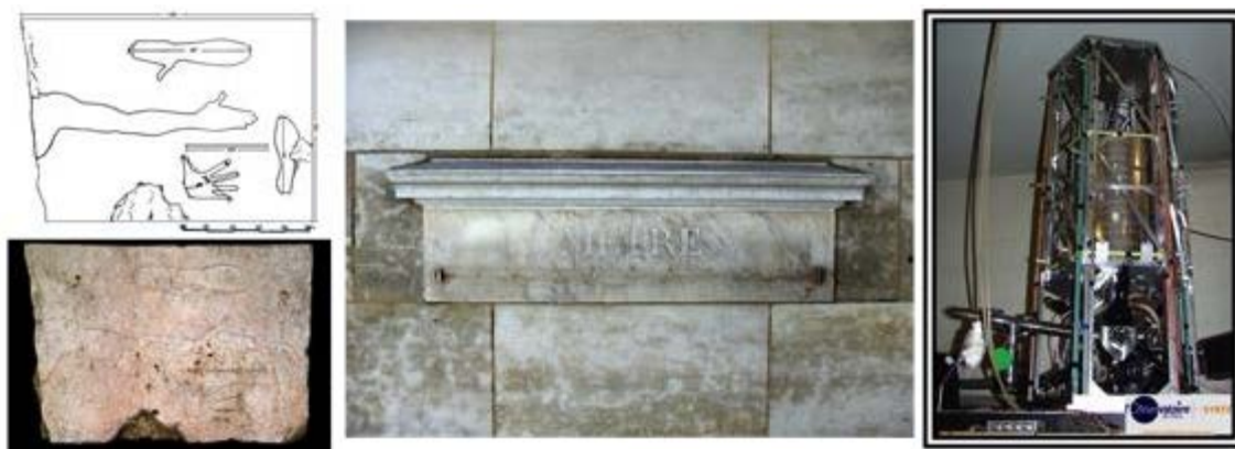
Figure 1-1 Illustration de l'évolution de la définition de longueur au cours des siècles. A gauche : « pierre de Salamine », étalon de longueurs universel pour la construction du Parthénon (Grèce, ~ - 440 av. J.C.). Au centre : mètre-étalon français (Paris, ~ 1796). A droite : fontaine atomique en fonctionnement au LNE-SYRTE (Paris, 1993). Depuis 1983, le mètre est défini comme la longueur parcourue dans le vide par la lumière pendant une fraction précise de seconde.
