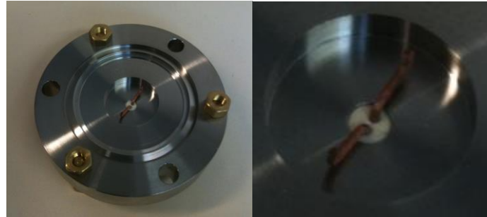
Figure 4-8 Photographie d'une bride CF40 portant un passage électrique amagnétique développé au LNE-SYRTE (côté vide). Au centre de la bride se trouve le passage en alumine (en blanc) à travers lequel passent les deux fils de cuivre.
