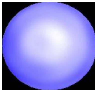
Figure 4-16 Profil d'intensité du faisceau laser à la sortie du collimateur (sans LRV) mesuré à l'analyseur de front d'onde. L'ouverture du Shack-Hartmann a un diamètre de 11,9 mm ; l'échelle est arbitraire.
