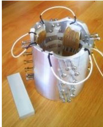
*Figure 4-7 Photographie du module de pression des joints indium et d'une des cales utilisées. Pour chaque hublot, douze vis permettent d'exercer une pression homogène sur chaque joint indium tandis que nous le chauffons de manière contrôlée. Ce module m'a permis de monter de manière reproductible les fenêtres de détection.*
