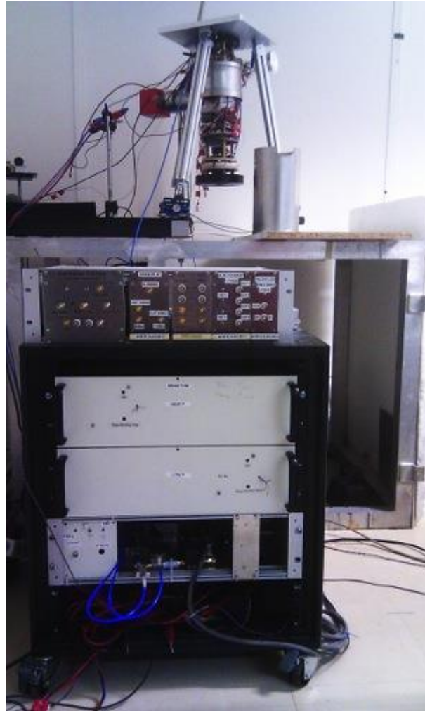
Figure 4-48 Photographie du prototype de gravimètre compacte MiniAtom. Au second plan en haut : la tête de capteur et son blindage magnétique. L'utilisation de la pyramide creuse permet de réaliser un interféromètre atomique avec un unique faisceau laser. Au premier plan : la source laser. L'utilisation de composants Télécom fibrés permet d'améliorer la robustesse et la compacité du banc laser. Le branchement d'une seule prise sur le secteur permet le fonctionnement du prototype d'interféromètre atomique.
