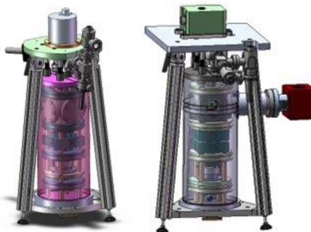
Figure 4-4 Evolution de la conception de la tête de senseur du prototype MiniAtom entre le début (à gauche) et la fin de ma thèse (à droite). Les principales modifications concernent l'enceinte à vide, le système de pompage et le blindage magnétique. Une description détaillée de la version finale est donnée sur la Figure 4-9. La photographie de la tête de senseur complète est donnée sur la Figure 4-14.
