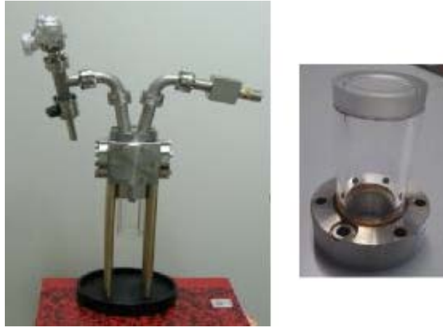
Figure 4-5 Première version de l'enceinte à vide du prototype MiniAtom développé au LNE-SYRTE. Nous n'avons pas pu obtenir une pression inférieure à quelque 10^{-7} hPa. A gauche : Enceinte à vide au complet sur son support mécanique. La réserve de rubidium est connectée par le conduit de gauche, une pompe ionique 2l/s par celui de droite. La pyramide se trouve au centre de la partie cubique accrochée à la bride supérieure entre les deux raccords. Sous elle, se trouve la cellule en verre. A droite : photographie de la cellule en verre qui s'est finalement fendue.
