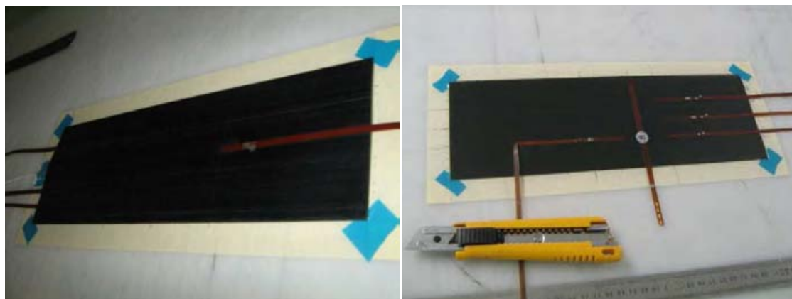
Figure IV.8 : pièces en composite carbone multi-instrumentées.
