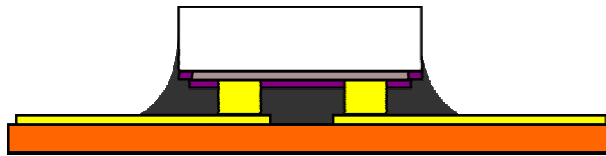
Figure III.15 : technique de report par flip-chip.
