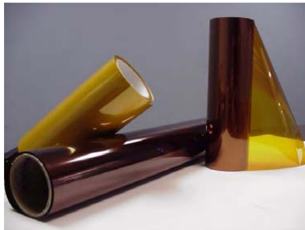
Figure III.6 : film de polyimide Kapton en rouleaux.
