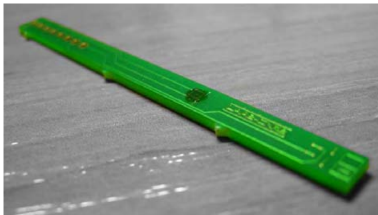
Figure III.5 : capteur monté sur circuit imprimé FR4 à finition nickel-or.
