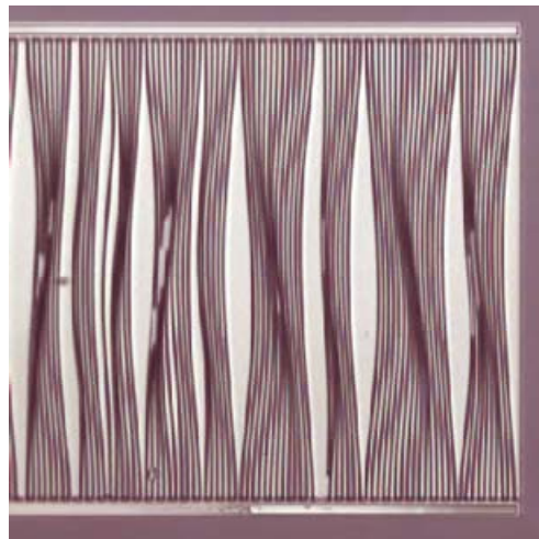
Figure II.32 : déplacement des motifs de résine de 6\mu\text{m} de résolution lors du séchage du wafer.
