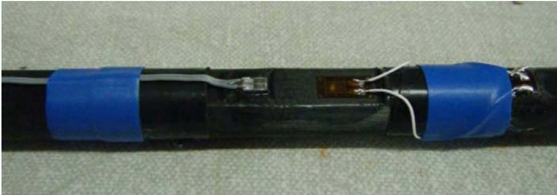
Figure IV.3 : instrumentation de cannes en carbone avec des capteurs de première génération.
