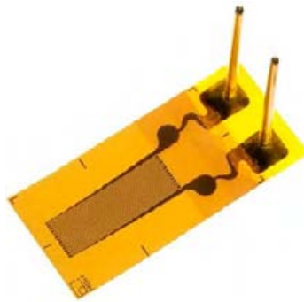
Figure I.6 : jauge de contrainte métallique « universelle ».
