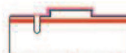
Lithographie pour l'ouverture de la silice (SiO 2 ) au dessus du ridge puis révélation
