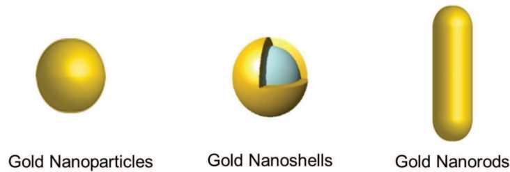
Figure I.11 – Représentation schématique de nanoparticules d'or typiques. [Oberleitner, 2013]
