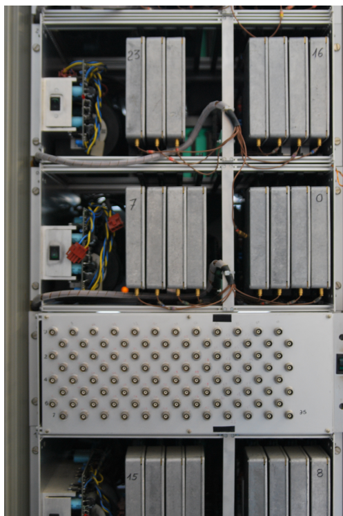
Figure IV.5 – Photographie de l'électronique d'émission. Une partie seulement des voies BNC est montrée.
