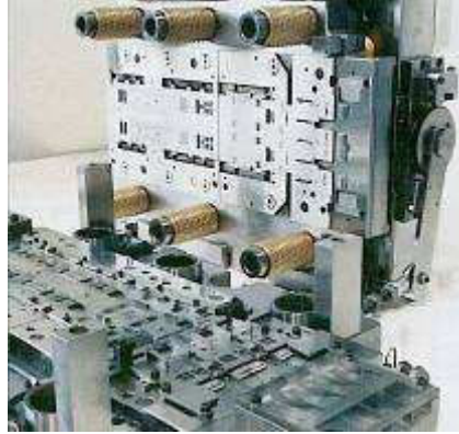
Figure 1. 6 : Exemple d'un outil progressif (Source : Diehl Augé Découpage, Besançon)
