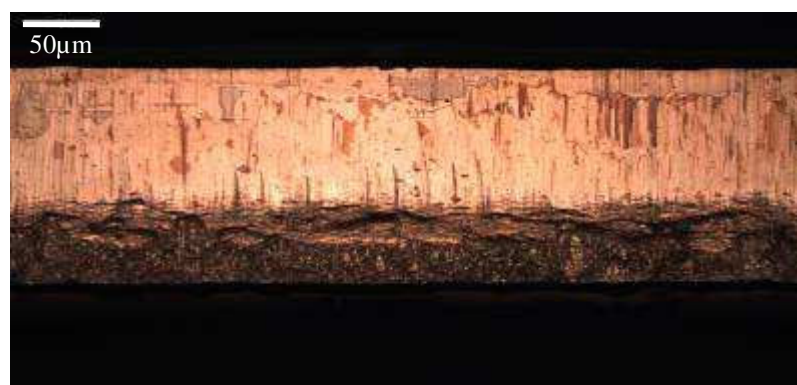
Figure 3. 39: Image optique d'un bord découpé sur une tôle CuFe0.1P0.3 à 6 500 coups de presse
