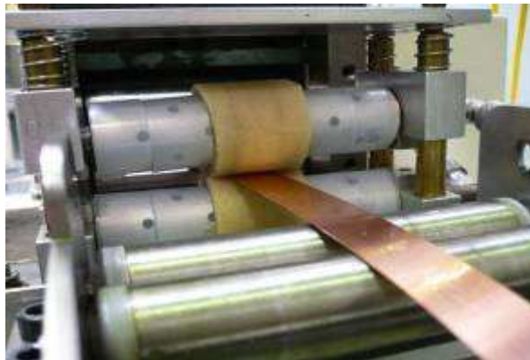
Figure 4. 26 : Système Raziol de lubrification des tôles
