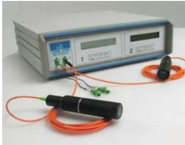
Figure 3.14: Crayon optique STIL et son contrôleur
