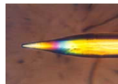
Fig. 4(e). SCF end taper
