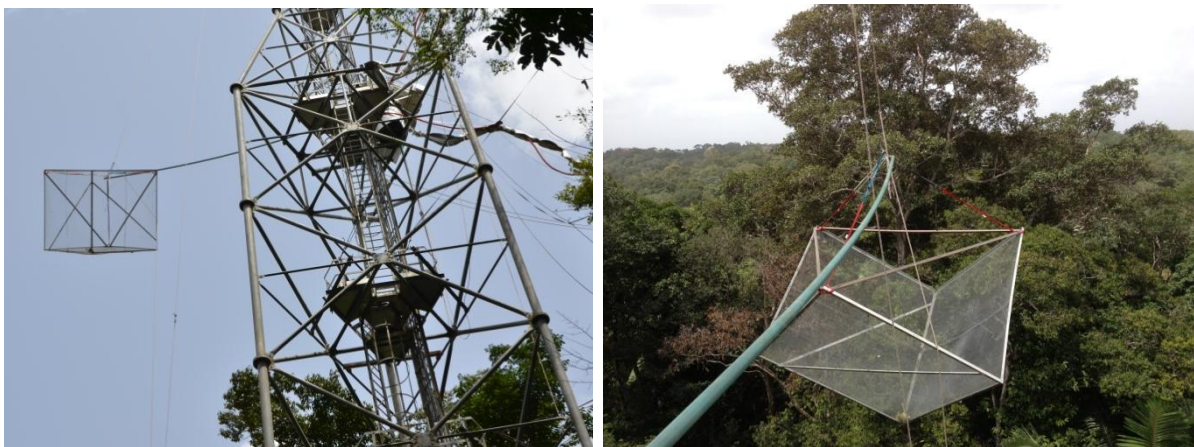
Figure 20. TropiScat : Essai de calibration avec le réflecteur trièdre suspendu à 25 m de haut.
