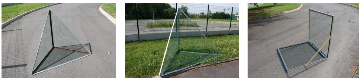
Figure 18. TreeScat : Réflecteurs trièdre à face triangulaire de 1 m d'arrête (gauche) et de 1,80 m d'arrête (milieu) et dièdre pliable de faces de 1 m par 1 m (droite) utilisés pour valider les mesures.
