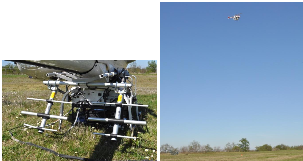
Figure 29. Antennes et VNA installés sur le drone (gauche) et drone instrumenté en vol lors d'une acquisition sur le trièdre (droite).
