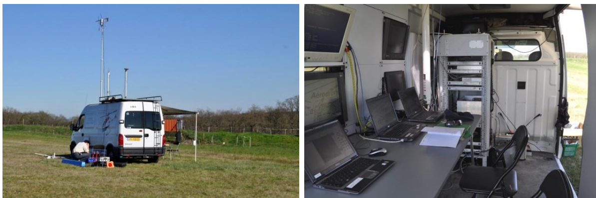
Figure 28. Véhicule de commande du drone vue de l'extérieur (gauche) et de l'intérieur (droite).
