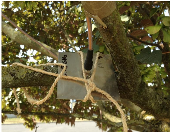
Figure 32. Antenne servant aux mesures fixée contre une branche d'un érable à Toulouse.
