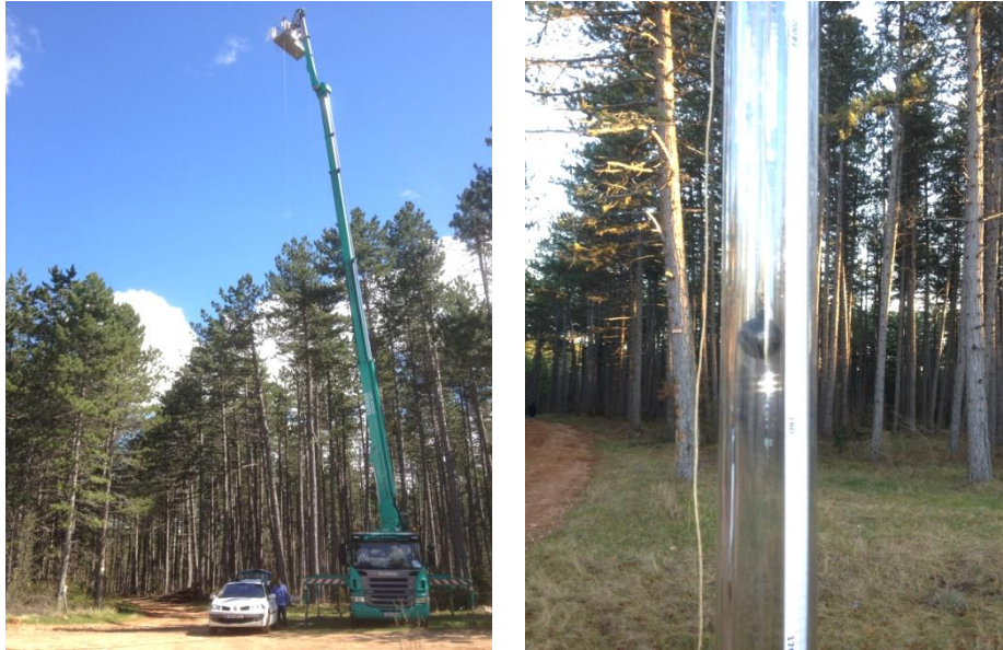
Figure 22. Camion nacelle avec les antennes fixées sur celle-ci (gauche) et système de mesure du déplacement vertical (droite).
