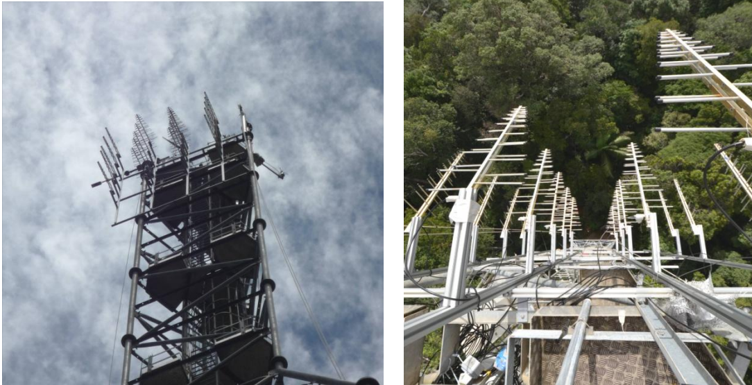
Figure 15. TropiScat : Réseau d'antenne vu de l'extérieur (gauche) et vu d'en haut de la tour (droite).
