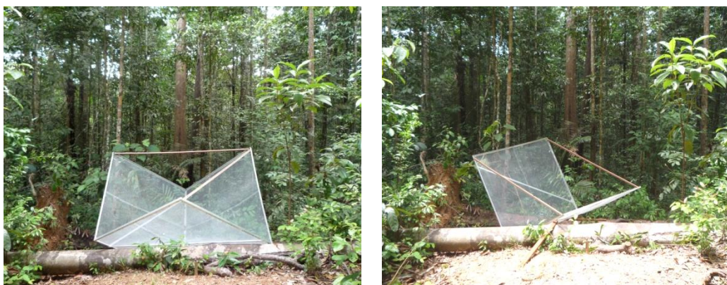
Figure 19. TropiScat : Réflecteurs trièdre à face carrées de 2 m d'arrête (gauche) et dièdre à face carrées de 2 m de côté (droite) utilisés pour valider les mesures.
