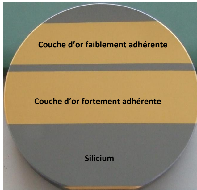
Figure 4.10 : Echantillon A - couches d'or de 1 µm d'épaisseur déposées sur un substrat de silicium. L'une est fortement adhérente au substrat, l'autre non.
