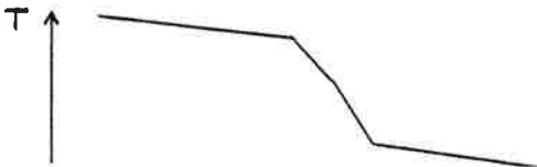
Fig. I.1 Origine des résistances thermiques de contact
