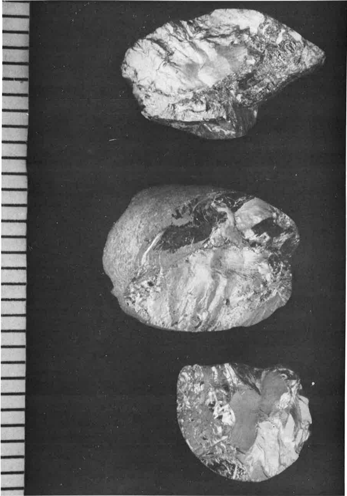
Cristaux de AgTe obtenus par la méthode de Bridgman (1 graduation = 1mm)
