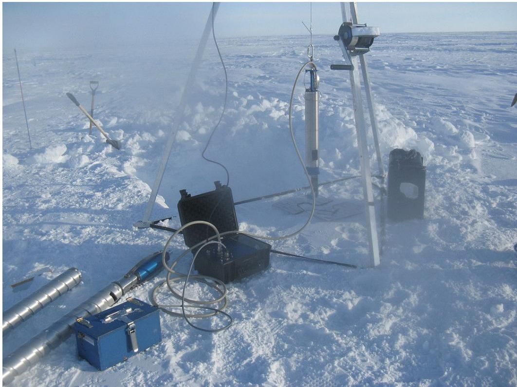
FIGURE 1.6 – Photographie de l'utilisation de l'instrument POSSUM pour la mesure de la surface spécifique de la neige sur la calotte Barnes.
