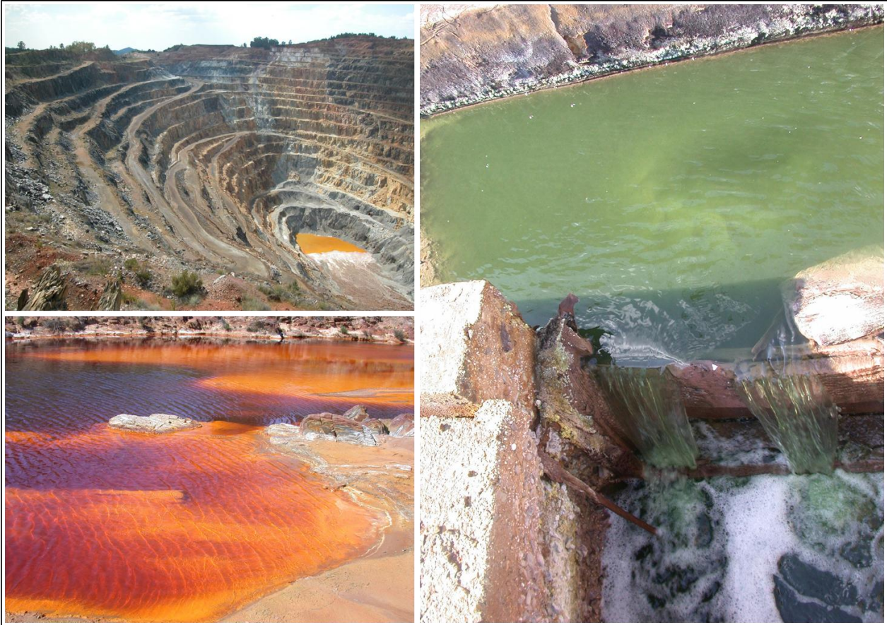
Figure 12. Mine acide à Rio Tinto en Espagne. La couleur rouge-brune de l'eau sur les photos de gauche est due à la présence de métaux, et particulièrement de fer oxydé en solution. L'eau de la photo de droite est à pH très bas, autour de 1, et sa couleur verte est due à du fer ferreux, non oxydé. Photographie de Purificación López-García.
