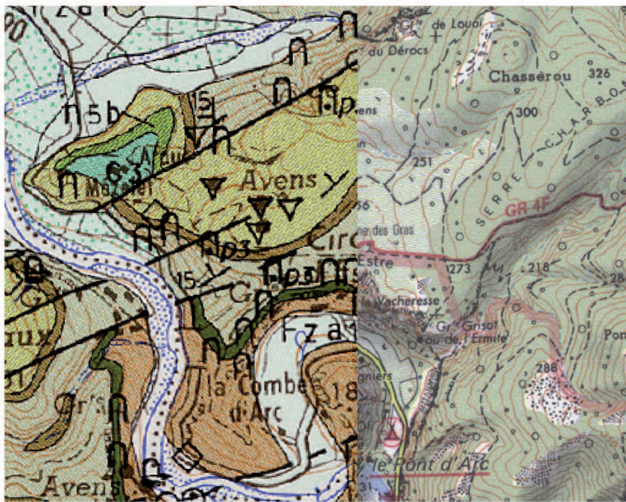
Figure 2.11 Mise en correspondance des informations géologiques (à gauche) et topographique (à droite). La bonne continuité entre les traits de parois ou les infrastructures routières sont de bons indices pour évaluer la qualité du géoréférencement d'une couche par rapport à une autre.
