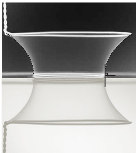
FIGURE 6.21: L'ajustement du profil est en accord avec l'analyse mathématique développée ci-dessus : la surface étudiée peut être vue comme une caténoïde symétrique tronquée de moitié, par symétrie plane.
