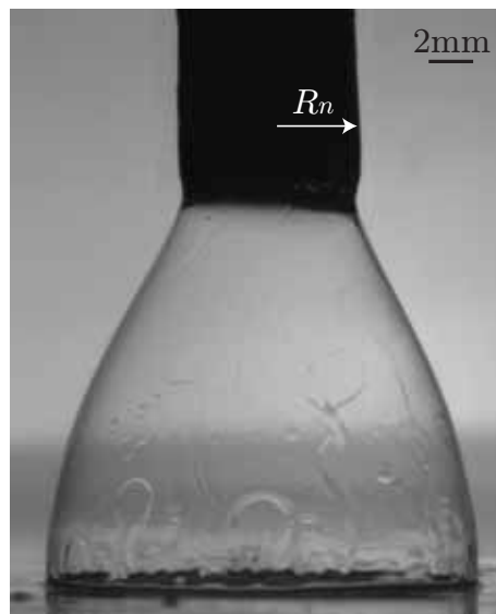
FIGURE 10.7: Lorsque le rapport R_n/R devient suffisamment grand, la bulle ne se détache pas de l'aiguille après son étalement.
