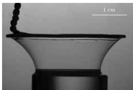
FIGURE 6.26: Apparaissant comme une variante expérimentale dans l'étude des demi-caténoïdes symétriques, l'utilisation d'un substrat solide mouillé permet en plus de s'affranchir d'effets hydrodynamiques liés à la présence du bain liquide.
