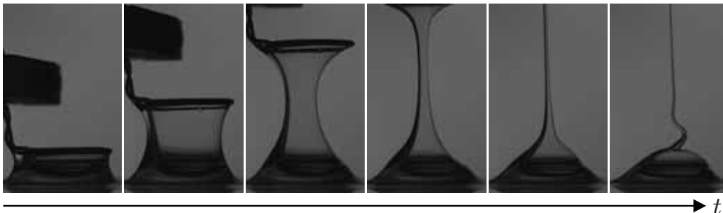
FIGURE 7.22: Séquence de photos illustrant l'effondrement d'un film visqueux (huile silicone de viscosité \eta_l=6.4 Pa.s), pour un cadre de rayon R=0.9 cm et une vitesse ascendante v = 0.3 m.s ^{-1} .
