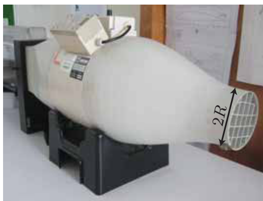
FIGURE 9.29: Photographie de la soufflerie utilisée (37304, Leybold) ; son rayon est noté R .
