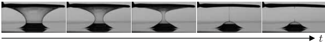
FIGURE 7.12: Effondrement quasi-statique d'une demi-caténoïde symétrique visqueuse, pour un cadre de rayon R = 1.1 cm.
