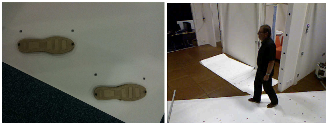
(a) Tampons imbibés d'encre sous les chaussures. (b) Un sujet marche sur le papier et le marque.
