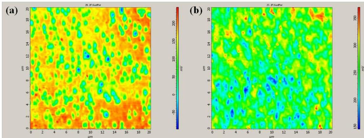
**Figure 10.** Image en potentiel surfacique de deux vitrocéramiques représentative avec différente conductivité (a)  $<10^{-8} \Omega^{-1}\cdot\text{cm}^{-1}$ ; (b)  $2.1\times 10^{-2} \Omega^{-1}\cdot\text{cm}^{-1}$
