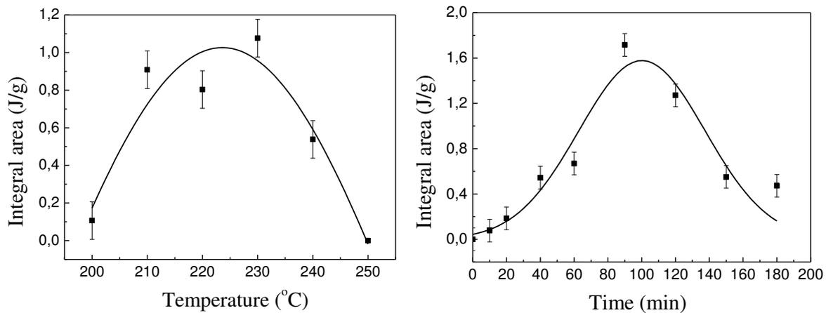
**Figure 6. Optimisation de la température et du temps de nucléation pour 40GeSe<sub>2</sub>-40Sb<sub>2</sub>Se<sub>3</sub>-20CuI**
