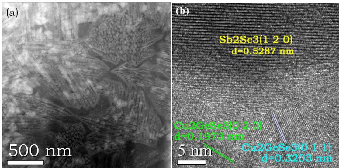
Figure 9. Images HRTEM de la vitrocéramique  $40\text{GeSe}_2\text{-}40\text{Sb}_2\text{Se}_3\text{-}20\text{CuI}$
