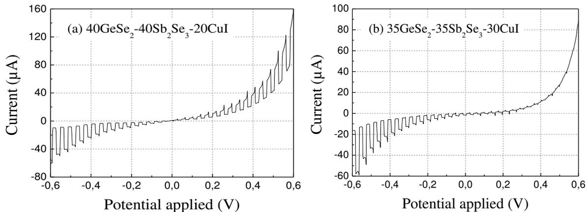
**Figure 5. Photocourant des deux vitrocéramiques dans la série 4**
