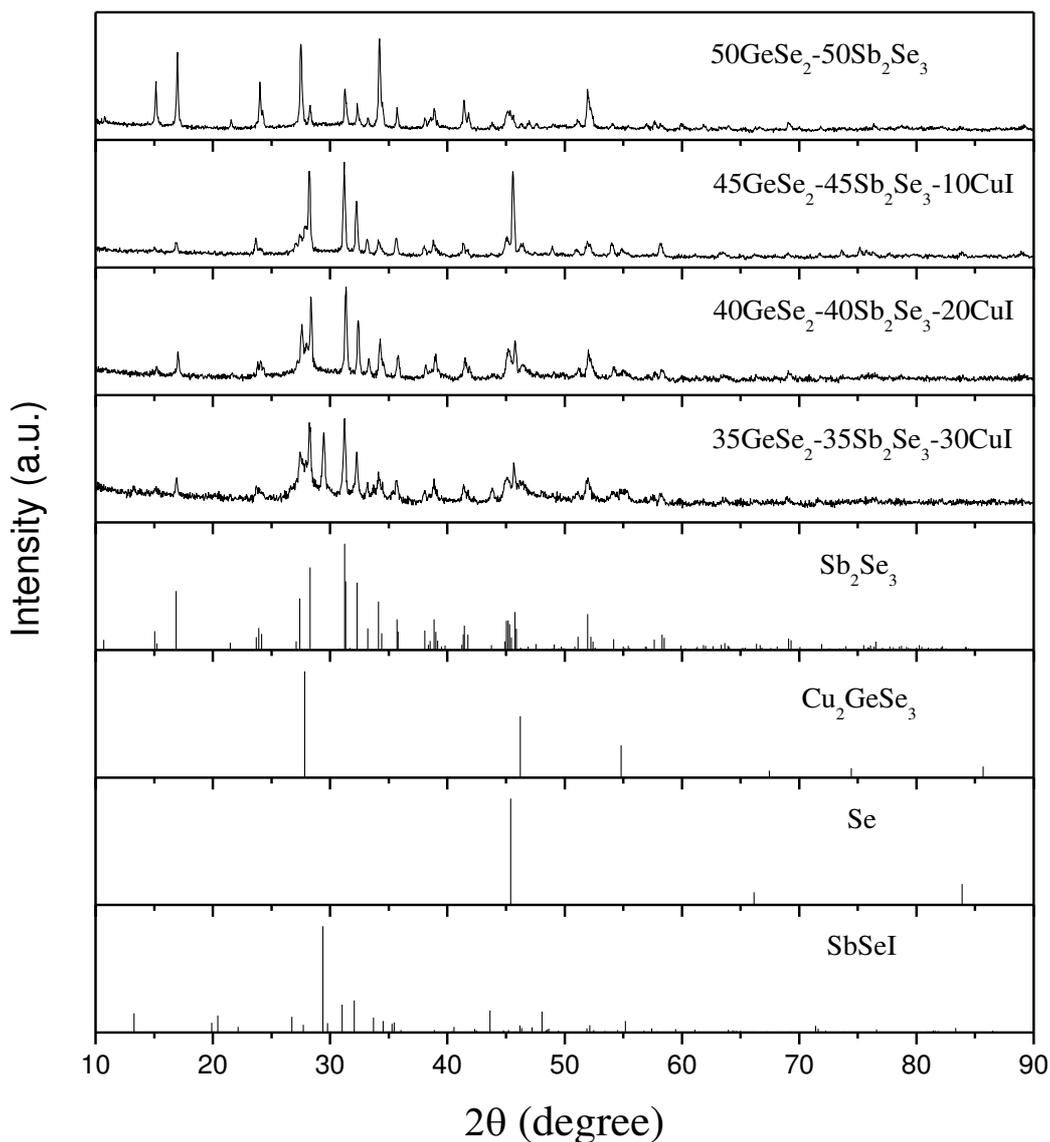
**Figure 4. Diffraction aux rayons X des vitrocéramiques dans la série 4 ((50-x/2)GeSe<sub>2</sub>-(50-x/2)Sb<sub>2</sub>Se<sub>3</sub>-xCuI)**
