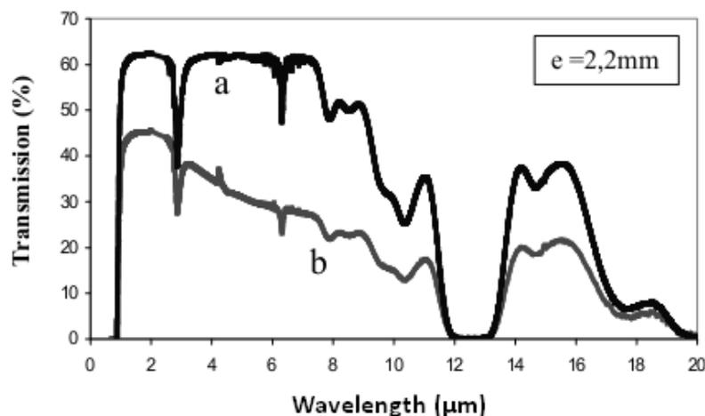
*Figure 1. Courbe de transmission du verre (a) et de la vitrocéramique (b) de la même composition  $60\text{GeSe}_2$ - $30\text{Sb}_2\text{Se}_3$ - $10\text{CuI}$*
