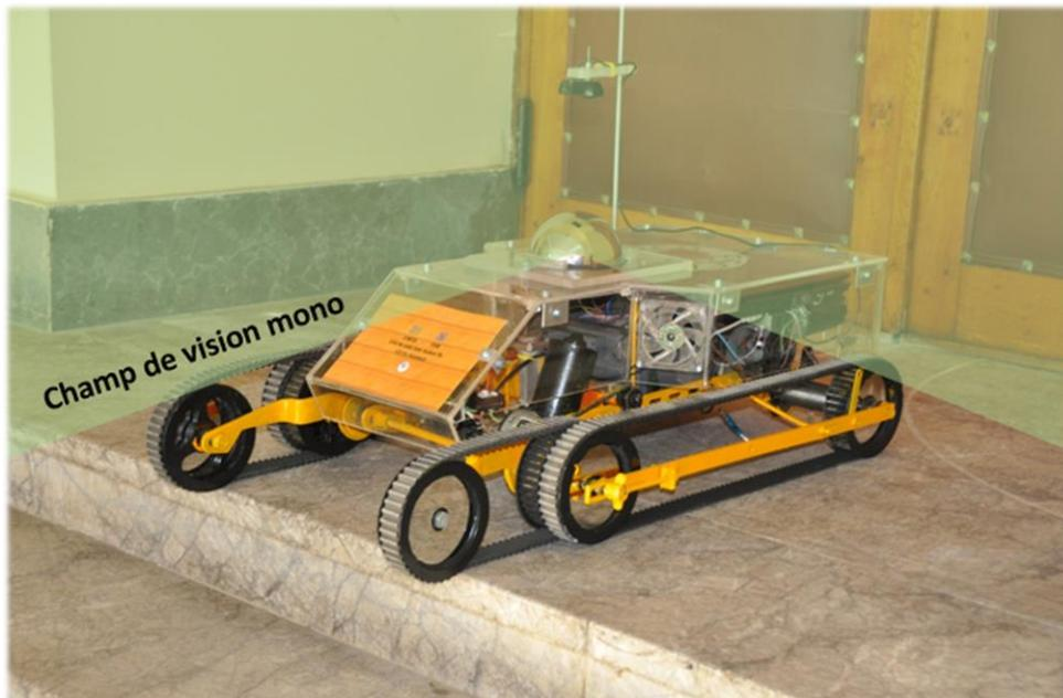
*Figure 4.6 : Capteur de vision omnidirectionnelle monoculaire.*
