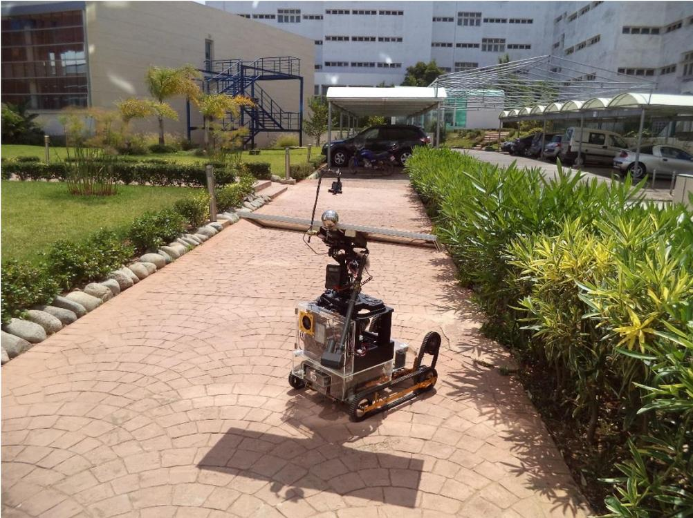
*Figure 4.28 : Robot mobile équipé d'un suiveur solaire.*
