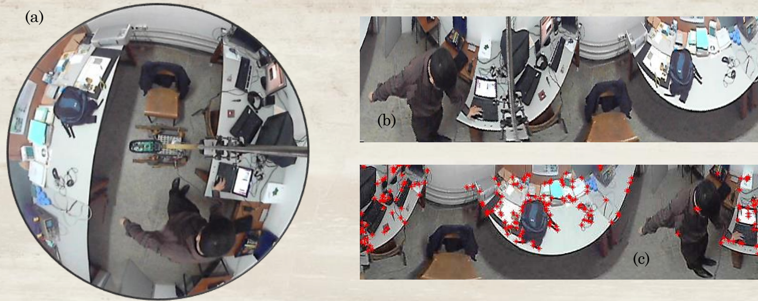
Exemple d'extraction des points d'intérêt. (a) Image catadioptrique acquise avec un miroir parabolique. (b) Image panoramique correspondante. (c) Extraction de points d'intérêt.
