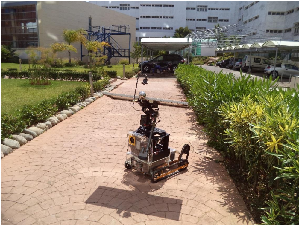
Figure 4.28 : Robot mobile équipé d'un suiveur solaire.
