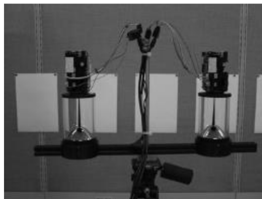
Figure 2.33 : système de vision omnistéréo binoculaire-H
