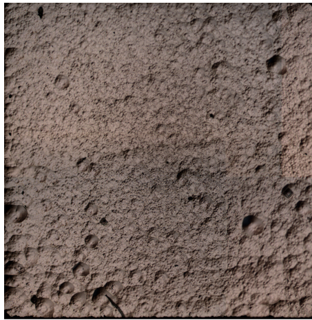
FIGURE 4.1 – Image grossie 5 fois des états de la surface des échantillons R_{ij}161 . L'échantillon fait 3 mm de côté.
