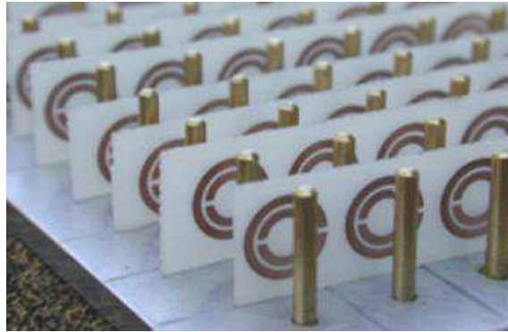
Figure 1.8 : La structure proposée par D. Smith qui combine les fils minces et les SRR pour avoir un milieu doublement négatif (métamatériau) [2]
