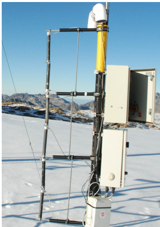
Figure 37 : photographie des FlowCapt développés par (Chritin et al., 1999), ici dans leur version de 0,3 m de hauteur
