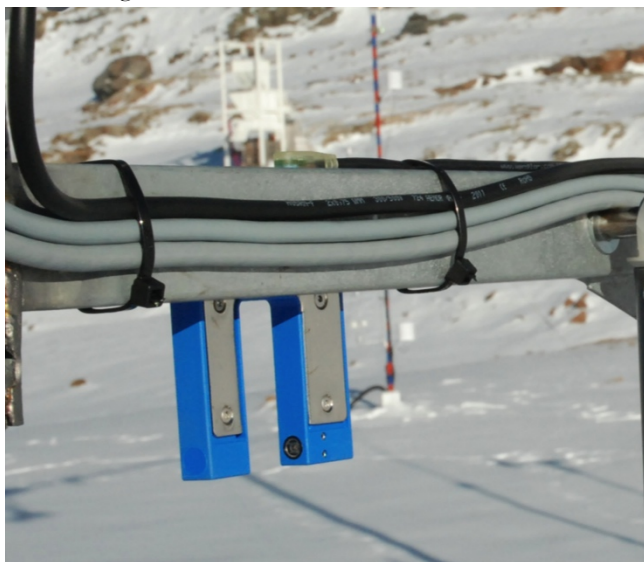
Figure 86 : appareil optique simple de la marque Wenglor® en comparaison au Col du Lac Blanc (crédit : Trouvilliez)
