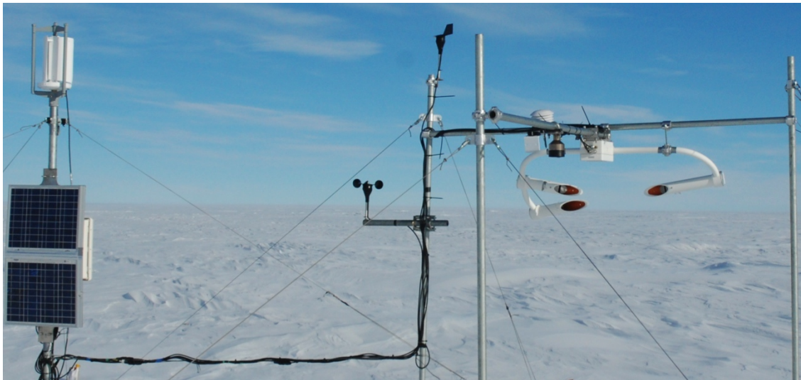
Figure 85 : le disdromètre PWS100 installé au point D47 de telle manière à ce que les plans de mesures soient perpendiculaires par rapport au sol (crédit : Trouvilliez)
