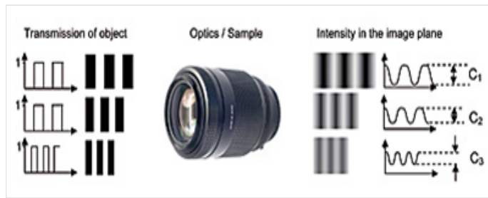
FIGURE 3.21 – Principe de la mesure d’une fonction de transfert de modulation
