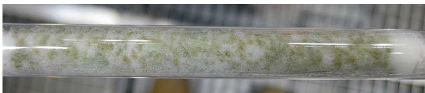
Figure 27 : Tube rempli avec des extrudés (jaunes/verts) et des billes de verre Duran de 60\ \mu\text{m} et exposé à des écoulements alternés d'heptane et d'azote. Les particules de verre Duran sont "invisibles" quand elles sont mouillées par de l'heptane.
