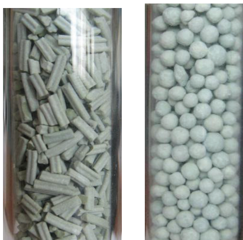
Figure 1 : Exemple de chargement de catalyseur extrudé trilobe et billes dans des tubes en verre
