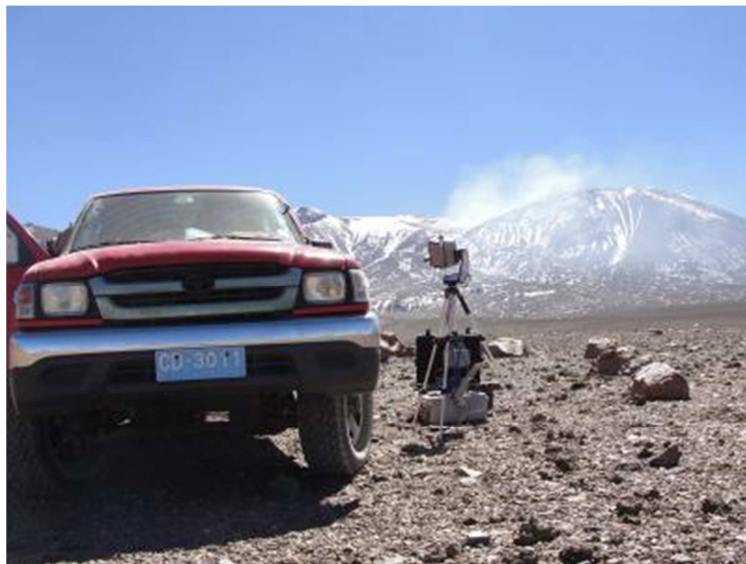
Figure IV.3: Système de mesures à distance des flux de SO 2 au Lascar (Photographie: F. Aguilera).
