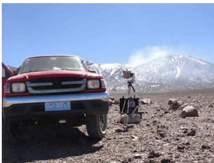
Figure IV.3: Système de mesures à distance des flux de SO 2 au Lascar (Photographie: F. Aguilera).
