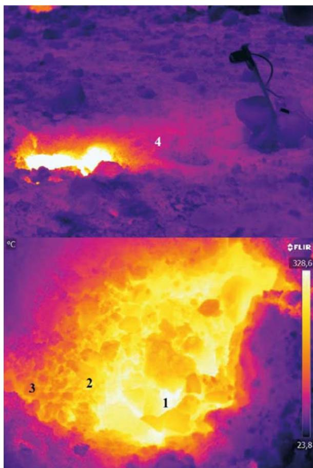
*Figure IV.15: Images réalisées par caméra thermique (S. Valade, pers. Comm.) montrant (en haut) la position du porte-filtre par rapport à l'évent fumerollien de haute-température ( $\geq 320^\circ\text{C}$ ) ainsi que les zones où nous avons collecté les différentes incrustations.*
