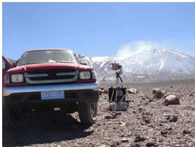
Figure IV.3: Système de mesures à distance des flux de SO<sub>2</sub> au Lascar (Photographie: F. Aguilera).
