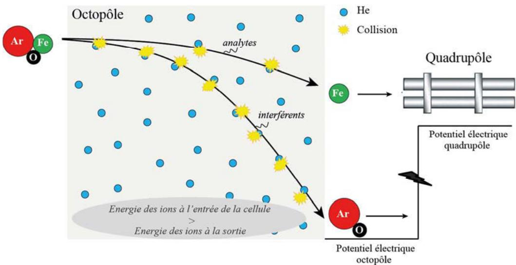
Figure II.5: Processus de suppression des interférences poly-atomiques en mode He ; exemple du  $^{56}\text{Fe}$  qui est interféré par  $^{40}\text{Ar}^{16}\text{O}$  (modifiée d'après Darrouzès and McCurdy, 2006).
