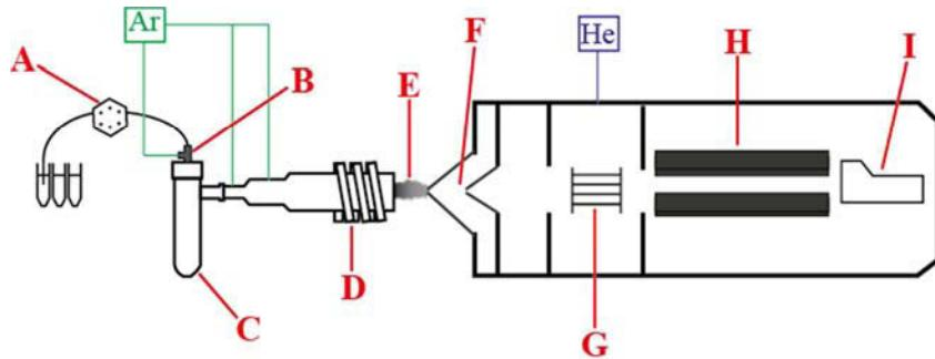
Figure II.3: Schéma fonctionnel du Q-ICP-MS Agilent 7500. A: pompe péristatique, B: nébuliseur, C: chambre de nébulisation, D: torche à plasma, E: plasma, F: interface et optique ionique, G: cellule de collision, H: quadripôle, I: multiplicateur d'électrons (détecteur).
