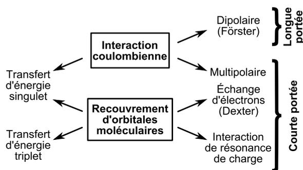
FIGURE 2.4 – Types d’interactions en jeu lors des échanges non radiatifs. Le recouvrement des orbitales moléculaires implique que les processus qui en dépendent sont de courte portée ( $< 1$  nm). *A contrario* les interactions coulombiennes agissent à plus grande distances (jusqu’à 8 nm – 10 nm).
