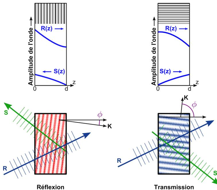
FIGURE 3.4 – Propagation des ondes dans des hologrammes en transmission et en réflexion. Dans les deux cas l'onde de référence  $R$  transfère son énergie à l'onde  $S$  au cours de sa propagation. Les dégradés de couleur indiquent l'orientation des franges d'interférences.
