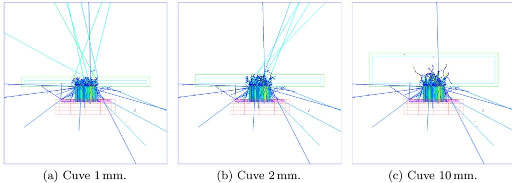
FIGURE 8.11 – Vues projetées selon l'axe  $x$  des géométries des cuvettes spectrométriques de 1 mm, 2 mm, 10 mm et traces des électrons. La coloration des traces est fonction de leur énergie.
