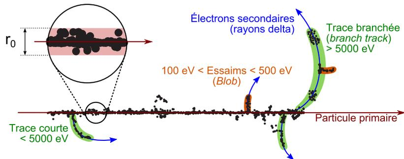
FIGURE 1.6 – Schéma d'une distribution typique des états excités et ionisés créés autour de la trajectoire d'une particule – directement – ionisante traversant un matériau. Repris de l'article de OLKO [17].
