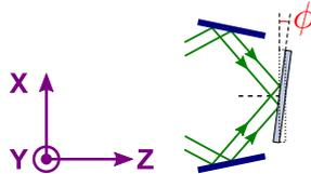
FIGURE D.1 – Schéma présentant les paramètres utilisés pour le calcul de l'erreur sur la période du réseau en fonction de l'inclinaison de l'échantillon.
