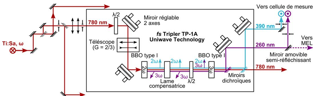
FIGURE 9.7 – Schéma de principe du tripleur de longueur d'onde TP-1A *fs* Tripler (UNIWAIVE TECHNOLOGIES).
