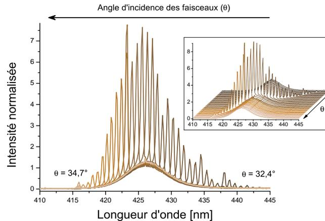
FIGURE 7.13 – Série de 10 accumulations de spectres d'émission laser DFB de l'Ultima Gold™ AB, réalisées avec le spectromètre ORIEL, à différents angles d'incidence des faisceaux structurants ( $\theta = 32,4^\circ - 34,7^\circ$ ). L'accordabilité de la longueur d'onde d'émission laser DFB en fonction de  $\theta$  est clairement visible.
