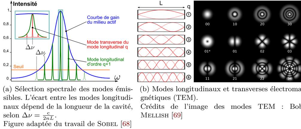
FIGURE 2.19 – Modes d'émission d'un milieu à gain dont la sélection spectrale est permise par une cavité de longueur  $L$ . Ils correspondent aux fréquences permises par la cavité, multiples de la fréquence fondamentale.
