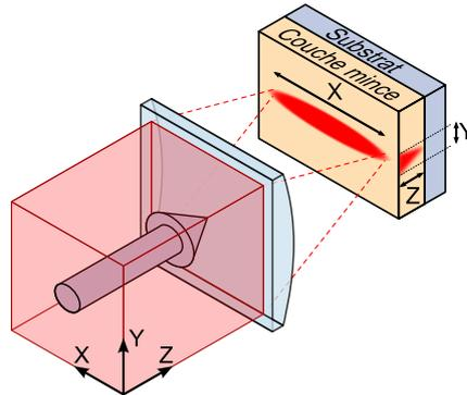
FIGURE 5.2 – Schéma explicatif des différents termes relatifs aux axes de propagation : longitudinal (suivant X), latéral (suivant Y), et transversal (suivant Z, *i.e.* perpendiculairement aux plans de réflexion).
