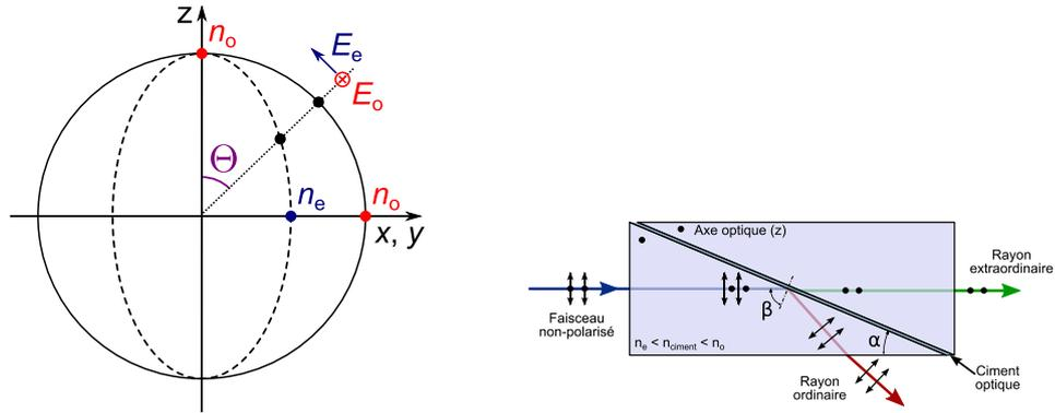
(a) Ellipse des indices. Représentation (exagérée) des indices de réfraction, ordinaire et extraordinaire (indices **e** et **o**), pour une fréquence  $\omega$  et dans différentes directions de propagation. Pour une onde se propageant avec un angle  $\Theta$  par rapport à l'axe optique  $z$ , les intersections avec les ellipses fournissent les valeurs des indices de réfraction.
