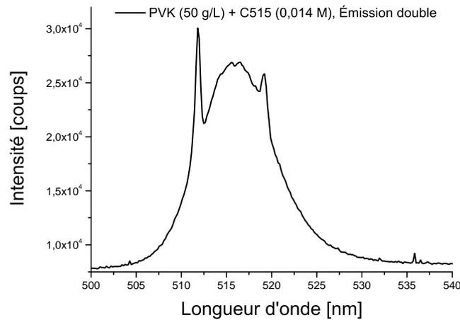
FIGURE 7.9 – Émission simultanée des modes d'émissions transverses électriques  $TE_0$  et  $TE_1$  dans un film de PVK ( $50 \text{ g} \cdot \text{L}^{-1}$ ) dopé Coumarine 515 ( $14 \cdot 10^{-3} \text{ M}$ ) de  $763 \text{ nm}$  d'épaisseur.
