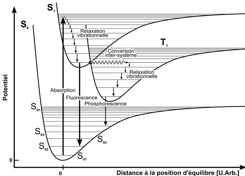
FIGURE 2.6 – Diagramme de FRANCK-CONDON des énergies potentielles d’une molécule aux états fondamentaux ( $S_0$ ), singulet ( $S_1$ ) et triplet ( $T_1$ ) excités. Les courbes d’énergie ont la forme du potentiel de LENNARD-JONES, potentiel vu par un électron lié à un atome.
