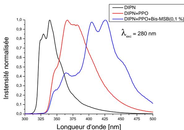
FIGURE 4.6 – Spectres d'émission ( $\lambda_{\text{exc}} = 280 \text{ nm}$ ) des solutions décomposées à partir de l'Ultima Gold™ AB. La contribution du PPO dans le spectre du scintillateur ternaire se distingue nettement dans la région  $330 \text{ nm} - 375 \text{ nm}$ .
