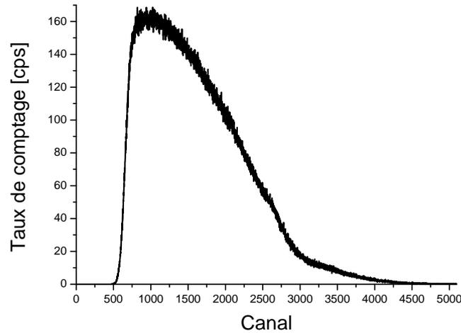
FIGURE 8.13 – Distribution en énergie mesurée avec MAESTRO de la cuve de 10 mm exposée à la source  $^{90}\text{Sr}/^{90}\text{Y}$ .
