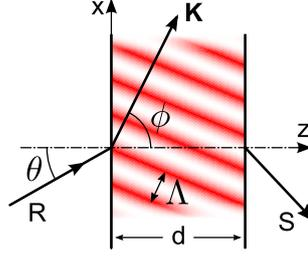
FIGURE 6.1 – Modèle d'un hologramme en volume avec franges inclinées, dans un réseau d'épaisseur  $d$ . Les interfranges traduisent la modulation de l'indice de réfraction et de la constante de gain.  $\mathbf{K}$  est le vecteur du réseau.
