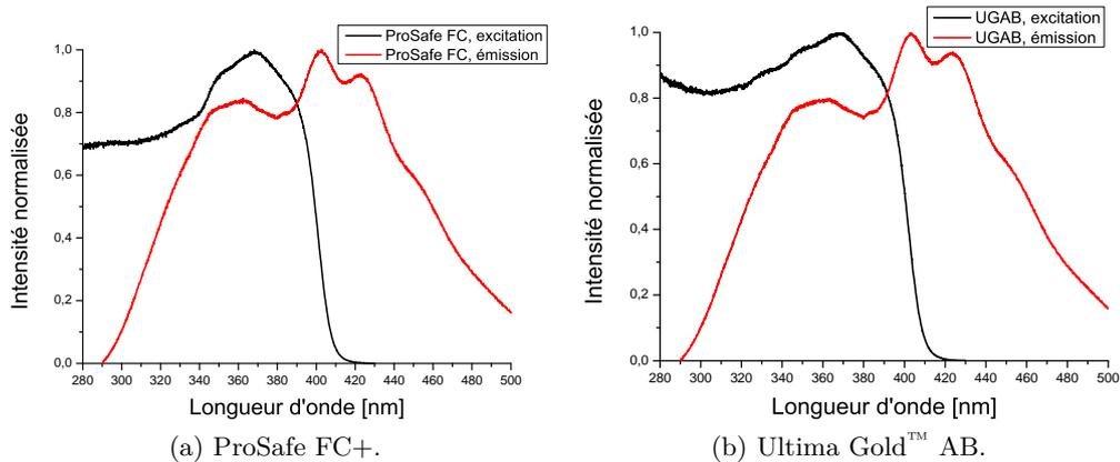
FIGURE 4.2 – Spectres d’excitation ( $\lambda_{\text{ém}} = 450 \text{ nm}$ ) et d’émission ( $\lambda_{\text{exc}} = 266 \text{ nm}$ ) du ProSafe FC+ et de l’Ultima Gold™ AB, réalisés en configuration de réflexion.
