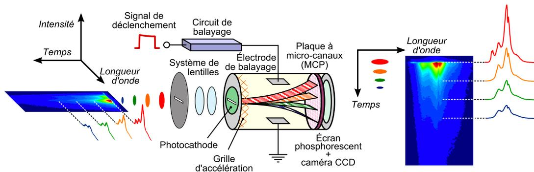
FIGURE 9.9 – Principe de fonctionnement d’une caméra à balayage de fente (*streak camera*). Adapté de *Guide to streak cameras* de HAMAMATSU [281].
