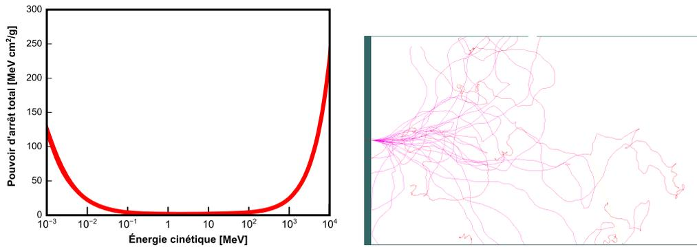
(a) Pouvoir d'arrêt du polystyrène pour des électrons d'énergie variable. Données issues de la base de données ESTAR [10]. (b) Trajectoires de 25 électrons de 300 keV dans 500 μm de Silicium, simulées par le module *shower* du code de calcul PENELOPE [11].
