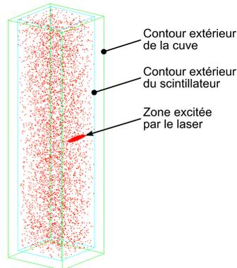
(a) Vue 3D de la cuve spectroscopique contenant le scintillateur et la source d'Américium simulée, et traces simulées (en rouge) des seules particules alpha dans le scintillateur. L'ellipse rouge sur la face droite correspond au volume excité par le laser.
