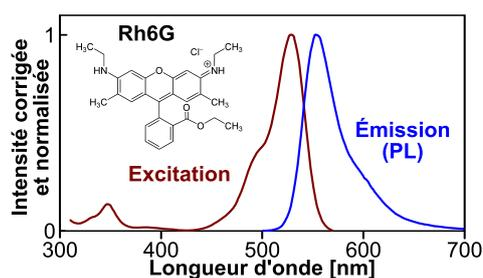
FIGURE 7.4 – Spectres d'excitation ( $\lambda_{\text{ém}} = 590 \text{ nm}$ ) et d'émission ( $\lambda_{\text{exc}} = 480 \text{ nm}$ ) de la Rhodamine 6G ( $10^{-5} \text{ M}$ ) mesuré avec le spectrofluorimètre FluoroMax-4 (HORIBA JOBIN YVON) en géométrie de transmission, et structure chimique de la Rhodamine 6G.
