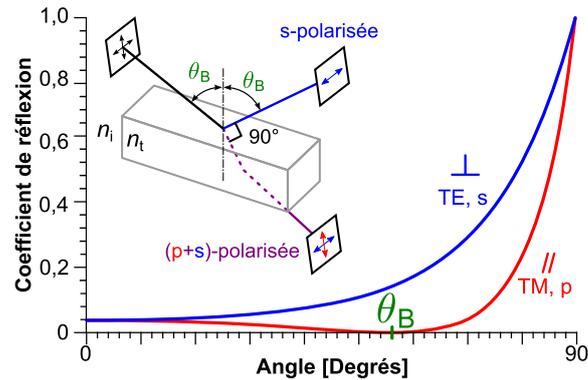
FIGURE 2.11 – Coefficients de réflexion typiques des ondes  $s$ -polarisée et  $p$ -polarisée par une surface diélectrique en fonction de l'angle d'incidence. À l'angle d'incidence de BREWSTER, l'onde  $s$ -polarisée est complètement réfléchi.
