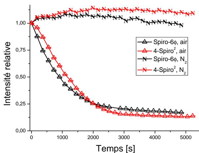
FIGURE 3.3 – Courbes de dégradation du signal laser d'échantillons sous excitation laser (excitation à 337 nm, fluence de  $26,7 \mu\text{J} \cdot \text{cm}^{-2}$  à 10 Hz) en fonction de la dose reçue par deux composés spiros en présence d'air ou de diazote. La photodégradation sous atmosphère d'oxygène est clairement visible.
