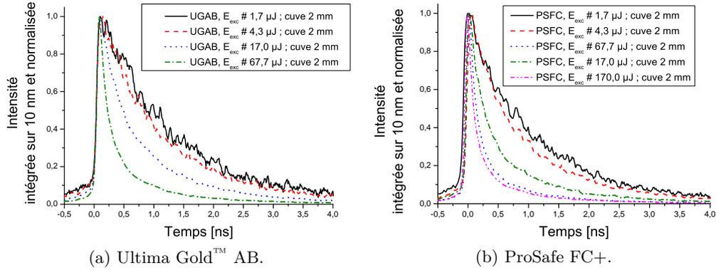
FIGURE 9.13 – Profils temporels de l'émission de la bande centrée à 430 nm, par les scintillateurs ProSafe FC+ et Ultima Gold™ AB, à différentes énergies d'excitation ( $\lambda_{\text{exc}} = 390 \text{ nm}$ ).
