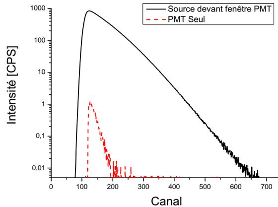
FIGURE 8.6 – Mesure avec MAESTRO de la sortie d'un photomultiplicateur, du mouvement propre (sans source) et du signal lorsqu'une source  $^{90}\text{Sr}/^{90}\text{Y}$  est située devant la fenêtre d'entrée du tube.
