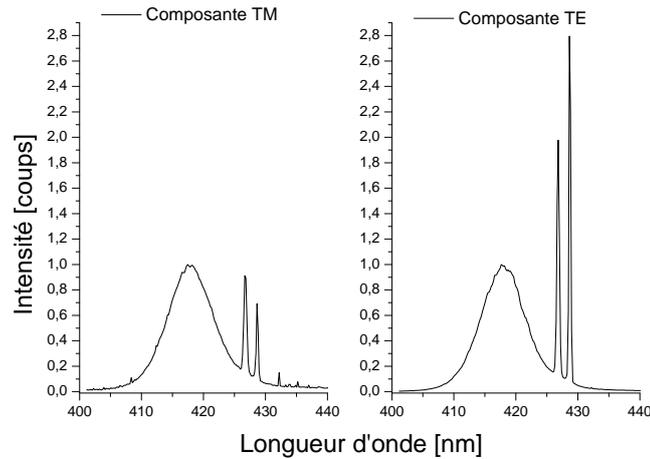
FIGURE 7.16 – Pics d’émission double, caractéristiques d’un réseau d’indice prépondérant par rapport au réseau de gain. L’écart entre les pics vaut (avec une incertitude  $\Delta\lambda \approx 0,15$  nm) : 1,97 nm pour la composante horizontale, et 1,79 nm pour la composante verticale. Scintillateur : UGAB. Mesures réalisées avec le spectromètre ORIEL.
