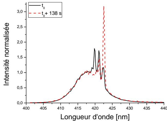
FIGURE 7.18 – Séries de mesures prises : juste après l’observation de la superposition de deux réseaux, dynamique et temporaire ( $t_0$ ), puis de nouveau, deux minutes plus tard ( $t_0 + 138$  s), lorsque le réseau permanent s’est effacé. Les spectres sont des séries de 50 accumulations mesurées avec le spectromètre ORIEL.
