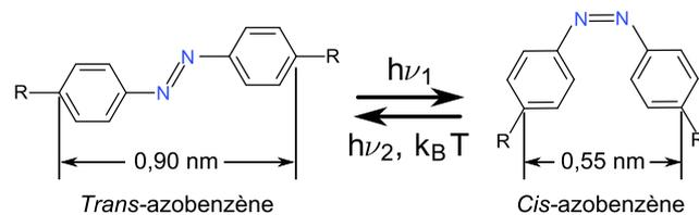
FIGURE 3.8 – Conformations *cis* (*Z*) et *trans* (*E*) de l'azobenzène (diphényldiazène). La transition *trans* à *cis* peut se faire par l'absorption d'un photon par la molécule. La relaxation vers la forme *trans*, plus stable, peut elle se faire optiquement ou par simple apport de chaleur.
