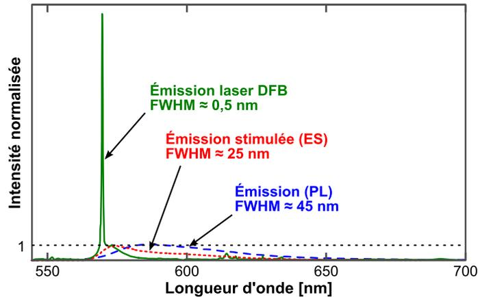
FIGURE 7.5 – Spectres de fluorescence (photoluminescence, PL) d'émission stimulée (ES) et DFB d'une solution de Rhodamine 6G à  $5 \cdot 10^{-3}$  M dans de l'éthanol. L'excitation est fournie par un faisceau de 532 nm de longueur d'onde. La mesure de la largeur à mi-hauteur de l'émission DFB est d'environ 0,5 nm mais est limitée par la résolution du spectromètre ORIEL utilisé pour cette mesure ( $\Delta\lambda = 0,15$  nm).
