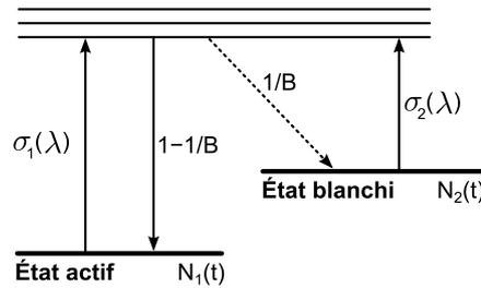
FIGURE 7.8 – Mécanisme de dégradation à un photon de DUBOIS [240], permettant de modéliser le photoblanchiment dans le temps d'une population active de  $N_1(t)$  fluorophores après  $B$  cycles d'excitation–désexcitation. Dans ce modèle,  $N_2(t)$  est la population de molécules blanchies,  $\sigma_1$  et  $\sigma_2$  sont les sections efficaces d'absorption des niveaux considérés et  $1/B$ , la probabilité qu'une molécule se dégrade. Figure tirée des travaux de GOUDKET [242].
