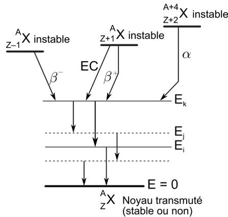
FIGURE 1.1 – Diagramme des mécanismes de décroissance radioactive.
