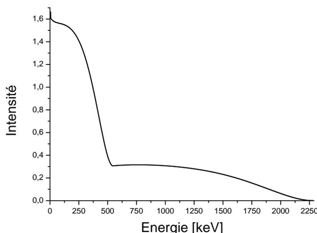
FIGURE 8.7 – Spectre d’émission bêta de la source  $^{90}\text{Sr}/^{90}\text{Y}$ . L’intégrale des intensités valant 1000, une pondération est implémentée dans la carte source du jeu de données ( $\text{WGT} = 1000$ ).
