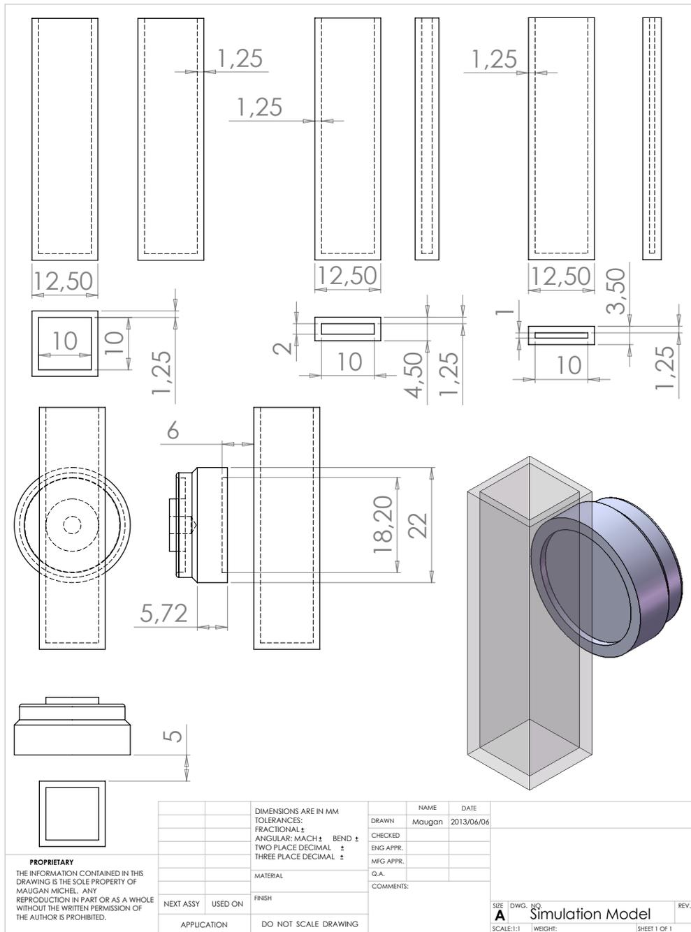
FIGURE E.1 – Plans cotés des cuves de quartz utilisées pour les expériences ainsi que de la source radioactive de  $^{90}\text{Sr}/^{90}\text{Y}$ . Une autoradiographie de la source nous permet d’estimer que l’émission a lieu sur toute la surface du renforcement (soit un disque de 18,20 mm de diamètre).
