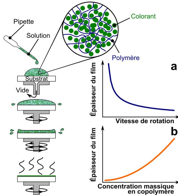
FIGURE 3.6 – Représentation des étapes de réalisation d’un film par le procédé de l’enduction centrifuge (alias *spin-coating*). Les graphiques, adaptés de *Spin Coating Theory* [171] et des travaux de HUBERT [172], représentent l’évolution de l’épaisseur  $h_f$  du film en fonction de la vitesse de rotation  $\dot{\theta} = d\theta/dt$  de l’enduction (a) et de la concentration massique  $C_m$  en copolymère (b), selon  $h_f \propto \frac{C_m^2}{\sqrt{\dot{\theta}}}$  [172].
