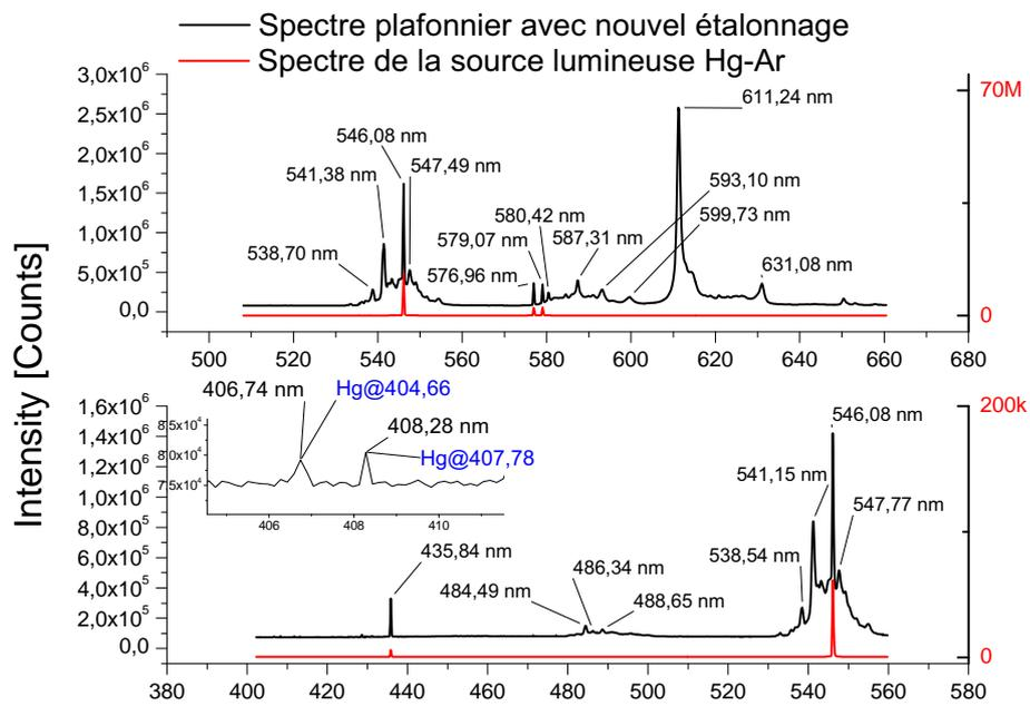
FIGURE C.1 – Spectres, de la source d'étalonnage Mercure-Argon CAL-2000 (AVANTES) [284] et des plafonniers, mesurés avec le spectromètre ORIEL.
