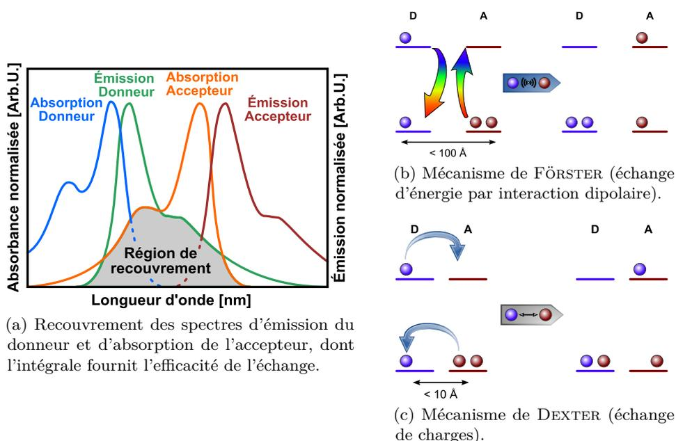
FIGURE 2.8 – Recouvrement spectral et illustration de l'échange d'énergie dans un système donneur – accepteur.
