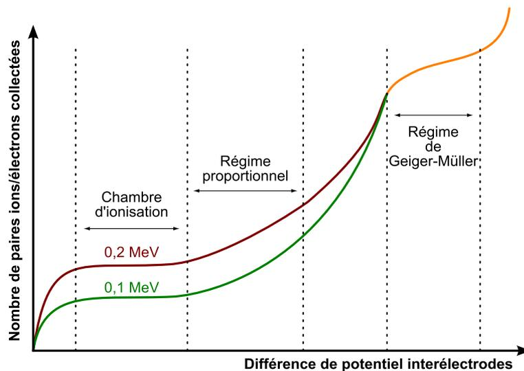
FIGURE 1.7 – Au passage d'une particule ionisante dans un matériau (gaz ou cristal, le champ électrique statique créé par les électrodes met en mouvement les porteurs de charges créés dans la trace, ce qui produit un signal électrique impulsionnel au niveau des électrodes. L'intégrale de cette impulsion est proportionnelle à l'énergie déposée par la particule dans le milieu.
