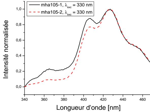
FIGURE 4.8 – Spectres d'émission ( $\lambda_{\text{exc}} = 330 \text{ nm}$ ) des scintillateurs mha105-1 et mha105-2. La concentration en Bis-MSB, doublée dans mha105-2 par rapport à mha105-1, permet un meilleur transfert de l'énergie du premier soluté (PPO), dont la structure spectrale, résiduelle dans mha105-1, est atténuée dans mha105-2.
