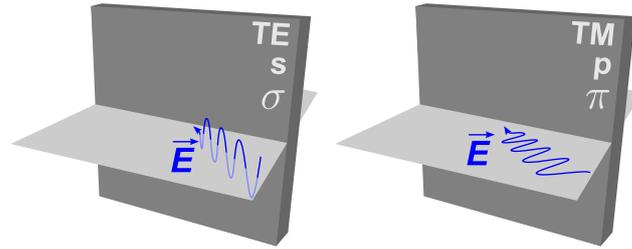
FIGURE 2.9 – Ondes transverses *électrique* (TE ou *s*-polarisée) et *magnétique* (TM ou *p*-polarisée).
