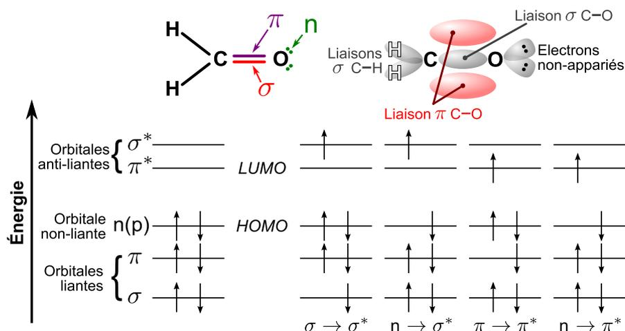
FIGURE 2.2 – Niveaux d’énergie et représentation des orbitales moléculaires dans le formaldéhyde : colinéaire (liaison  $\sigma$ ) et à recouvrements latéraux (liaisons  $\pi$ ). Adapté de *Initiation à la fluorescence moléculaire* de Bernard VALEUR [28].
