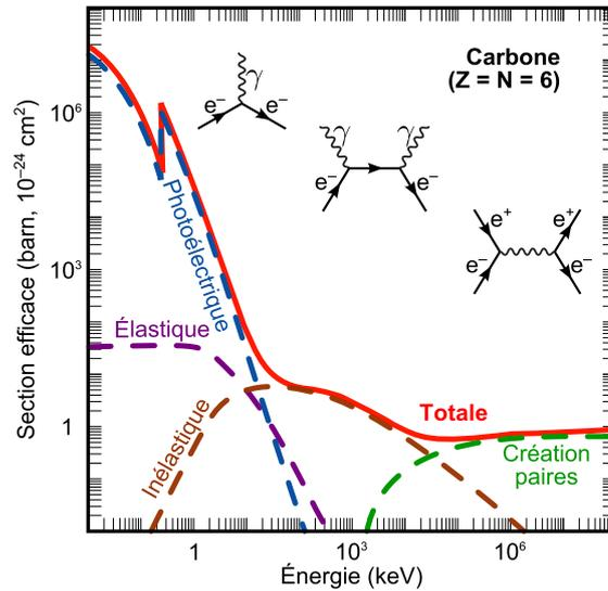
(a) Sections efficaces dans le carbone en fonction de l'énergie des photons, indiquant les contributions respectives associées aux effets photoélectrique, Compton (diffusion inélastique et -quasi-élastique dite diffusion THOMSON) et de production de paire. Les diagrammes de FEYNMAN correspondent à l'effet photoélectrique (à gauche), à la diffusion COMPTON (à droite) et à la création de paire et à l'annihilation  $e^+e^-$  (à droite).
