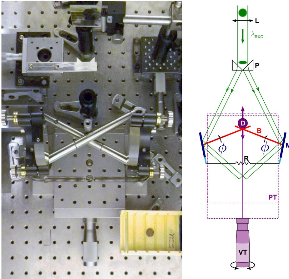
FIGURE 7.2 – Photographie et schéma en vue de dessus (sans l'échantillon) du montage permettant la contrarotation des miroirs à partir d'une platine de translation (**PT**, translée par un vernier *ad hoc*, **VT**), via un doigt (**D**) en liaisons glissière et pivot avec les bras (**B**) liés aux axes de rotation des miroirs (**M**). Un ressort de rappel (**R**) permet de contraindre l'ensemble.
