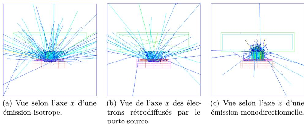
FIGURE 8.10 – Visualisation des traces des électrons émis par la source  $^{90}\text{Sr}/^{90}\text{Y}$  dans différentes géométries d'émission par rapport à une cuve spectrométrique de 10 mm. La coloration des traces est fonction de leur énergie.
