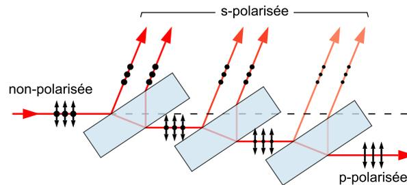
FIGURE 2.12 – Empilement de lames à l'incidence de BREWSTER permettant, en défléchissant plusieurs fois une fraction de la composante  $s$ -polarisée, de transmettre un faisceau  $p$ -polarisé. Les flèches indiquent la direction du champ électrique.
